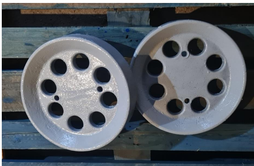
Slika 28. Utezi stražnjih kotača traktora koji se koriste za dodatnu stabilnost
