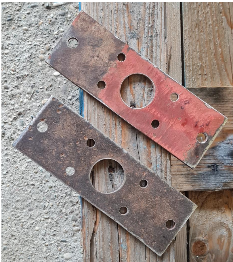
Slika 26. Izrađeni dodatni nosači za cilindre
