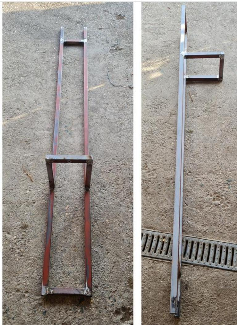
**Slika 24. Stupovi konstrukcije po kojima klize cilindri**
