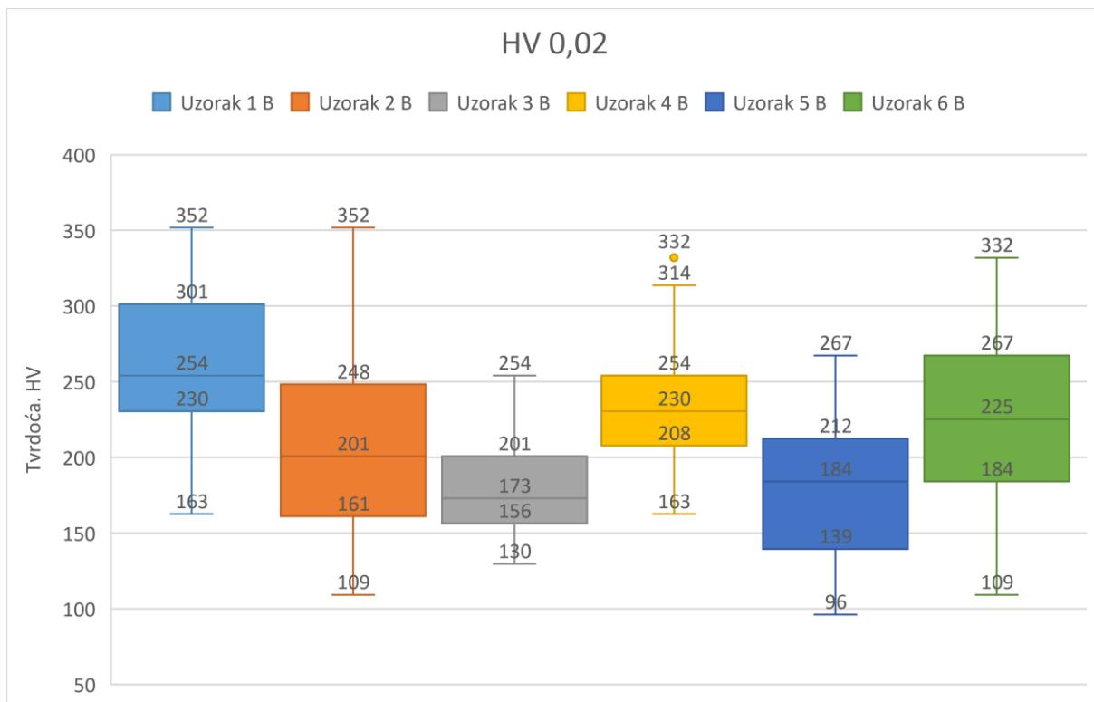
**Slika 62.** Rezultati mjerjenja tvrdoće HV 0,02 za uzorke uz rub navara (B)
