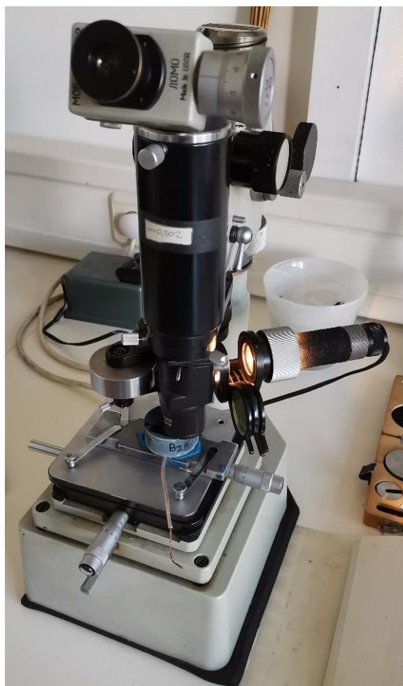
Slika 54. Mikrotvrdomjer „PMT-3“
