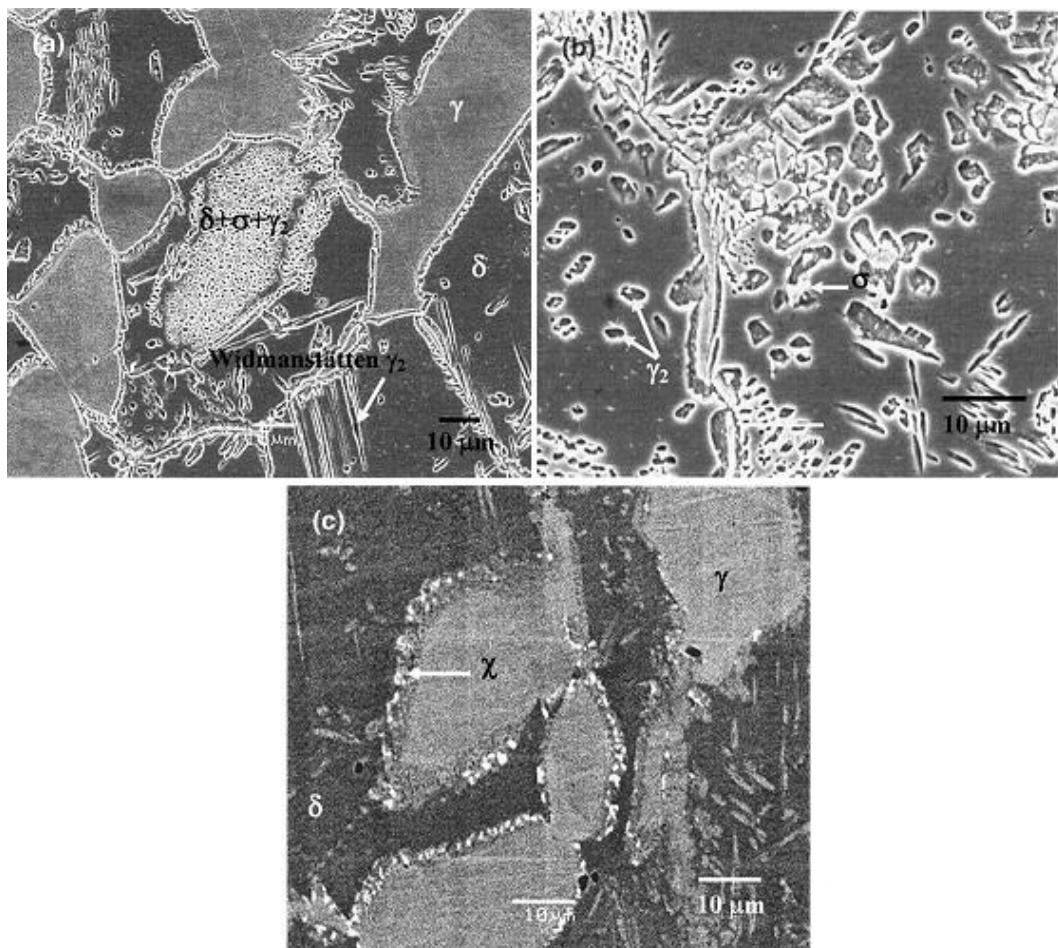
**Slika 8.** SEM fotografije a) mikrostruktura nakon žarenja na  $800\text{ }^{\circ}\text{C}$  u trajanju od 30 min gdje se vidi ferit ispunjen sigma fazom i Widmanstattenovim sekundarnim austenitom; b) na istom uzorku sigma-faza i  $\gamma_2$ ; c) prikaz malih bijelih čestica chi-faze [10]
