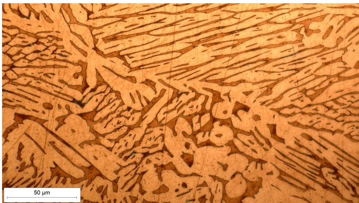
Slika 43. Mikrostruktura uzorka 4 B snimljena pri povećanju od 500×
