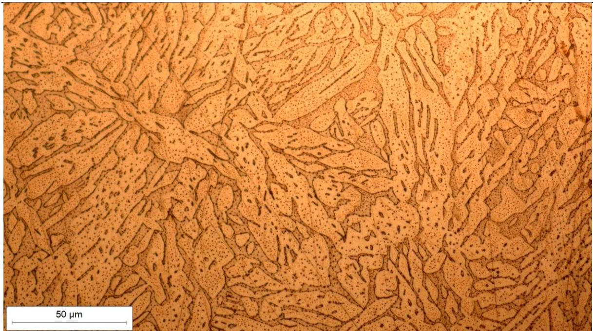
Slika 47. Mikrostruktura uzorka 5 B snimljena pri povećanju od 500×
