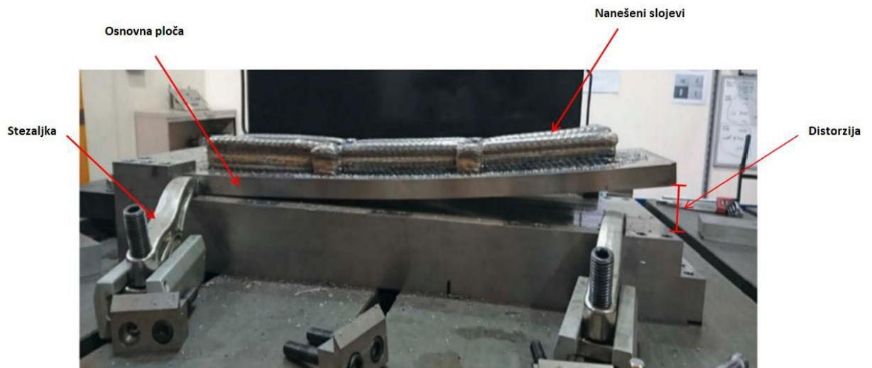
Slika 18. Deformacije nastale uslijed velikog unosa topline [9]
