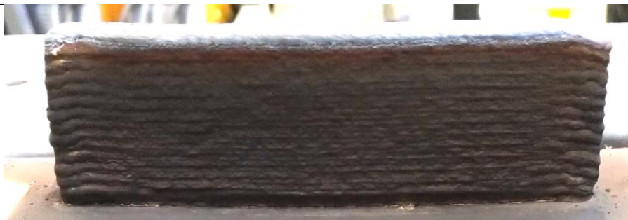
Slika 24. Navareni zid dupleks čelika
