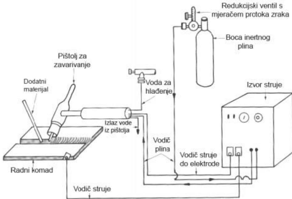
Slika 21. Shema opreme za TIG postupak zavarivanja [16]
