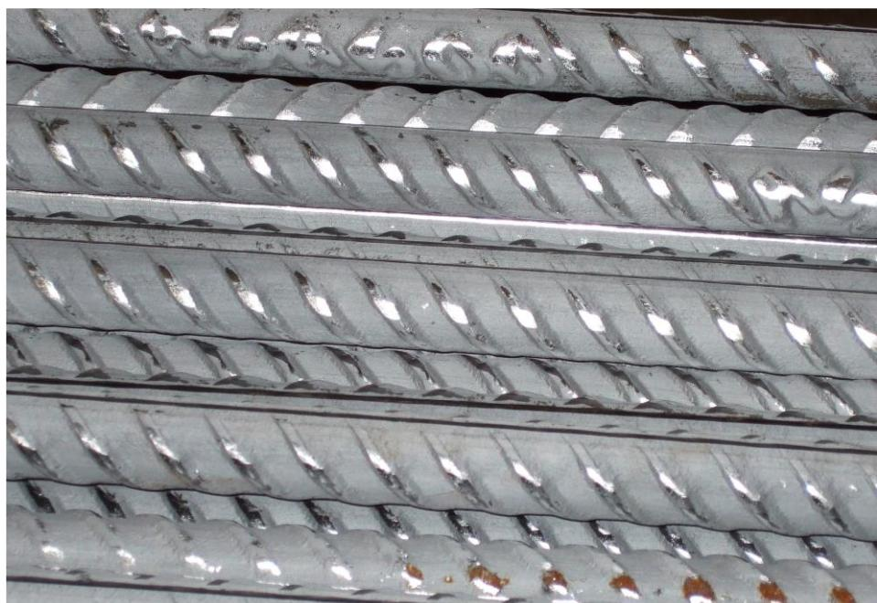
Slika 11. Armatura proizvedena od dupleks čelika [6]
