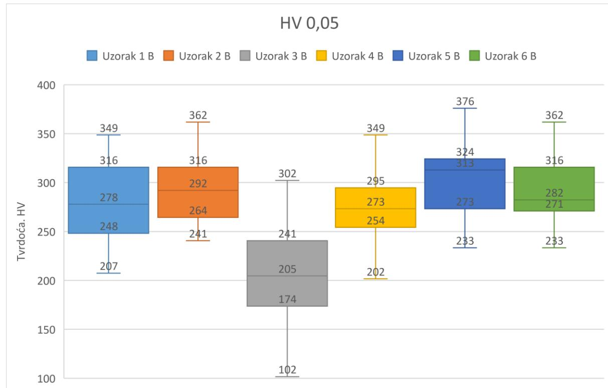
Slika 60. Rezultati mjerjenja tvrdoće HV 0,05 za uzorke uz rub navara (B)
