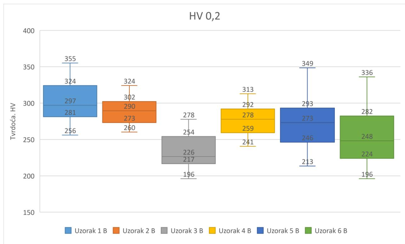
**Slika 56. Rezultati mjerena tvrdoće HV 0,2 za uzorce uz rub navara (B)**
