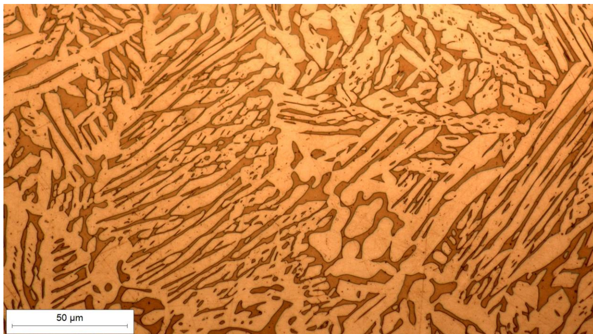
Slika 53. Mikrostruktura uzorka 6 B3 snimljena pri povećanju od 500×
