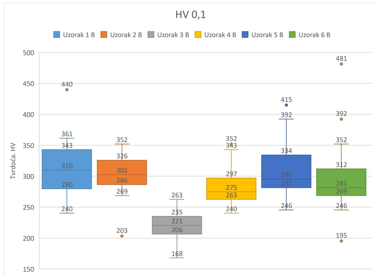
**Slika 58. Rezultati mjerjenja tvrdoće HV 0,1 za uzorke uz rub navara (B)**
