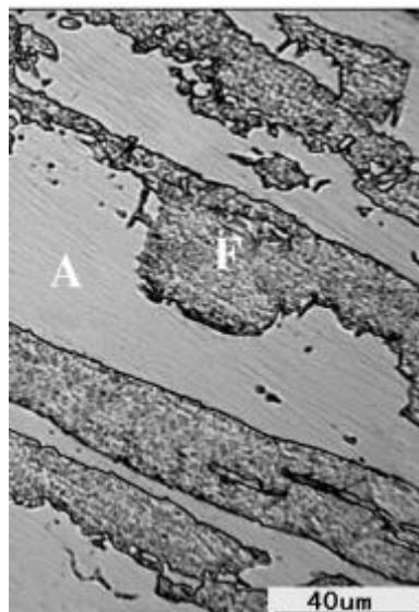
Slika 1. Mikrostruktura dupleks čelika (A-austenit, F-ferit) [2]
