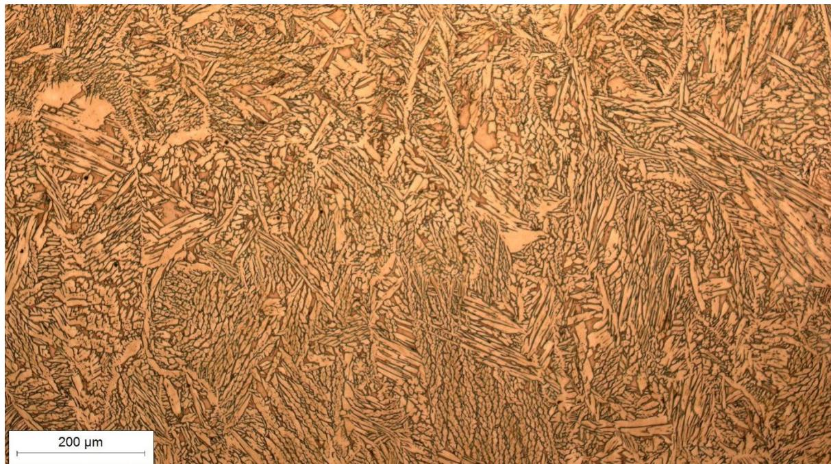
Slika 32. Mikrostruktura uzorka 1 B3 snimljena pri povećanju od 100×
