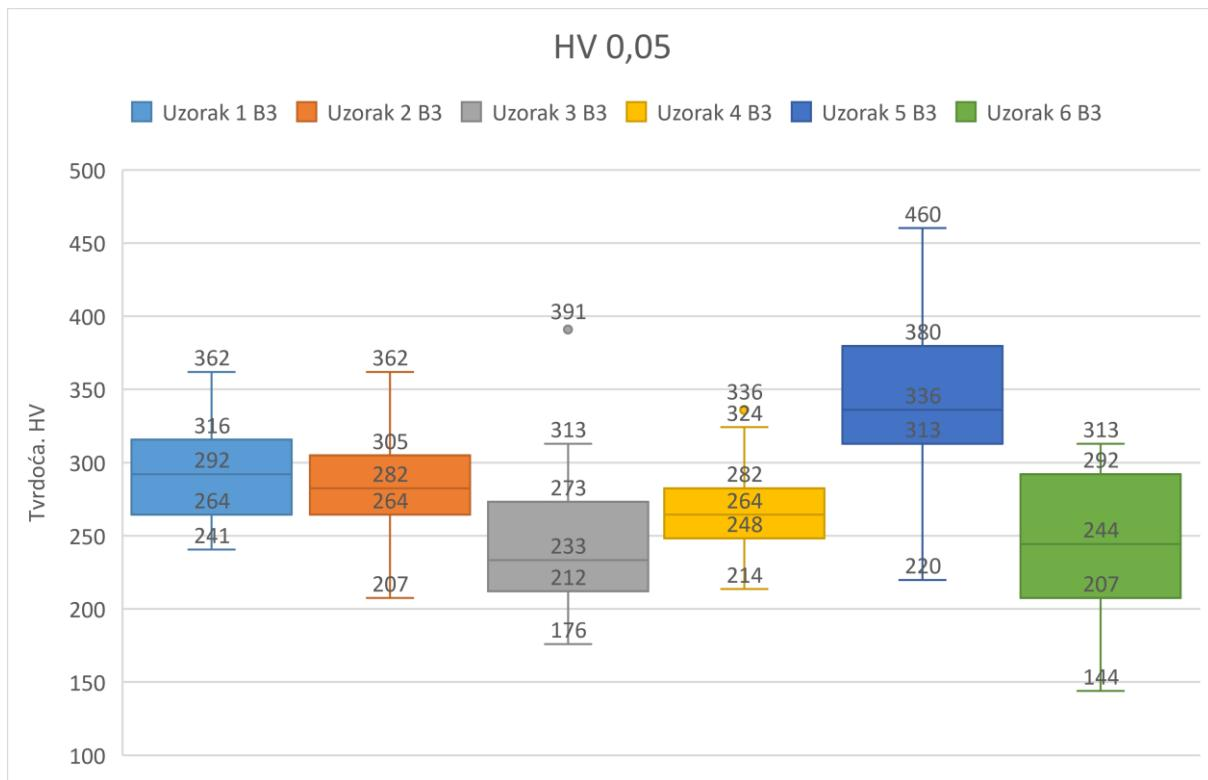
**Slika 61.** Rezultati mjerjenja tvrdoće HV 0,05 za uzorke u sredini navara (B3)
