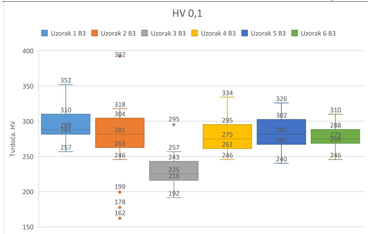
Slika 59. Rezultati mjerjenja tvrdoće HV 0,1 za uzorke u sredini navara (B3)
