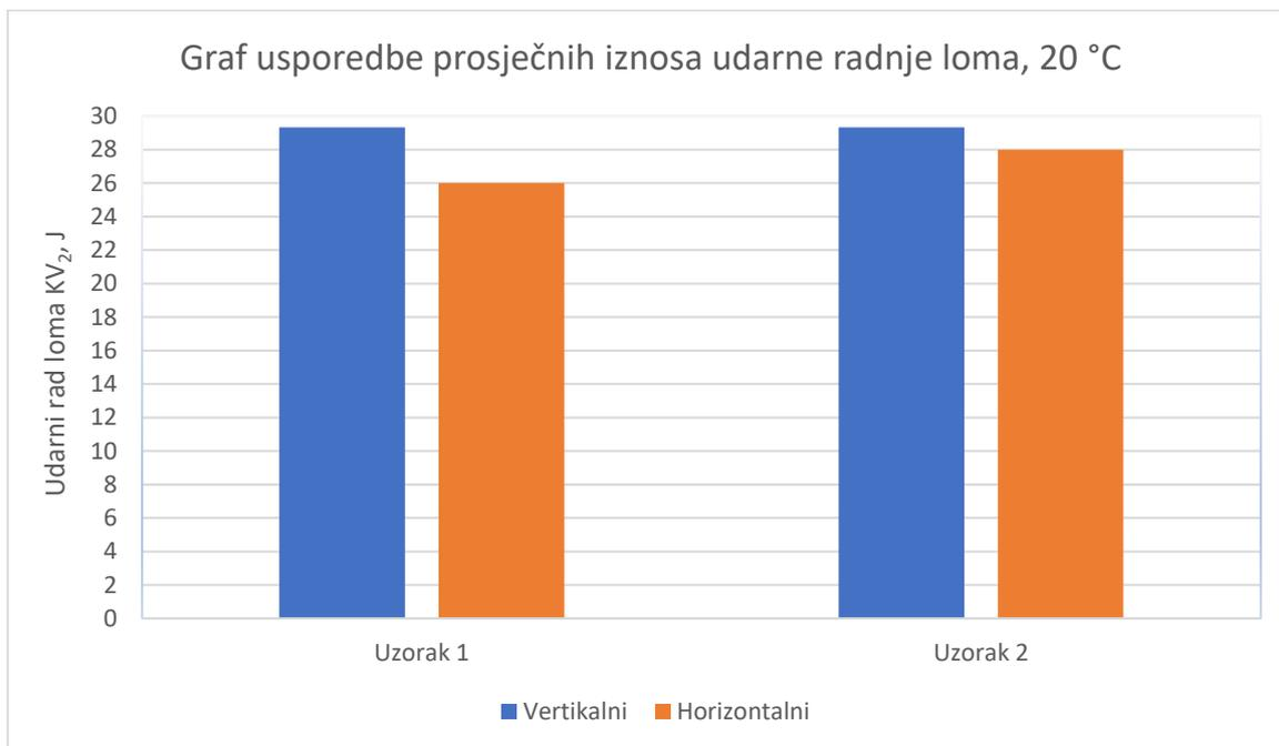
Pošto su epruvete debljine 2,5 mm, iznose udarne radnje loma potrebno je pomnožiti s četiri da bi se dobila stvarna udarna radnja loma.
