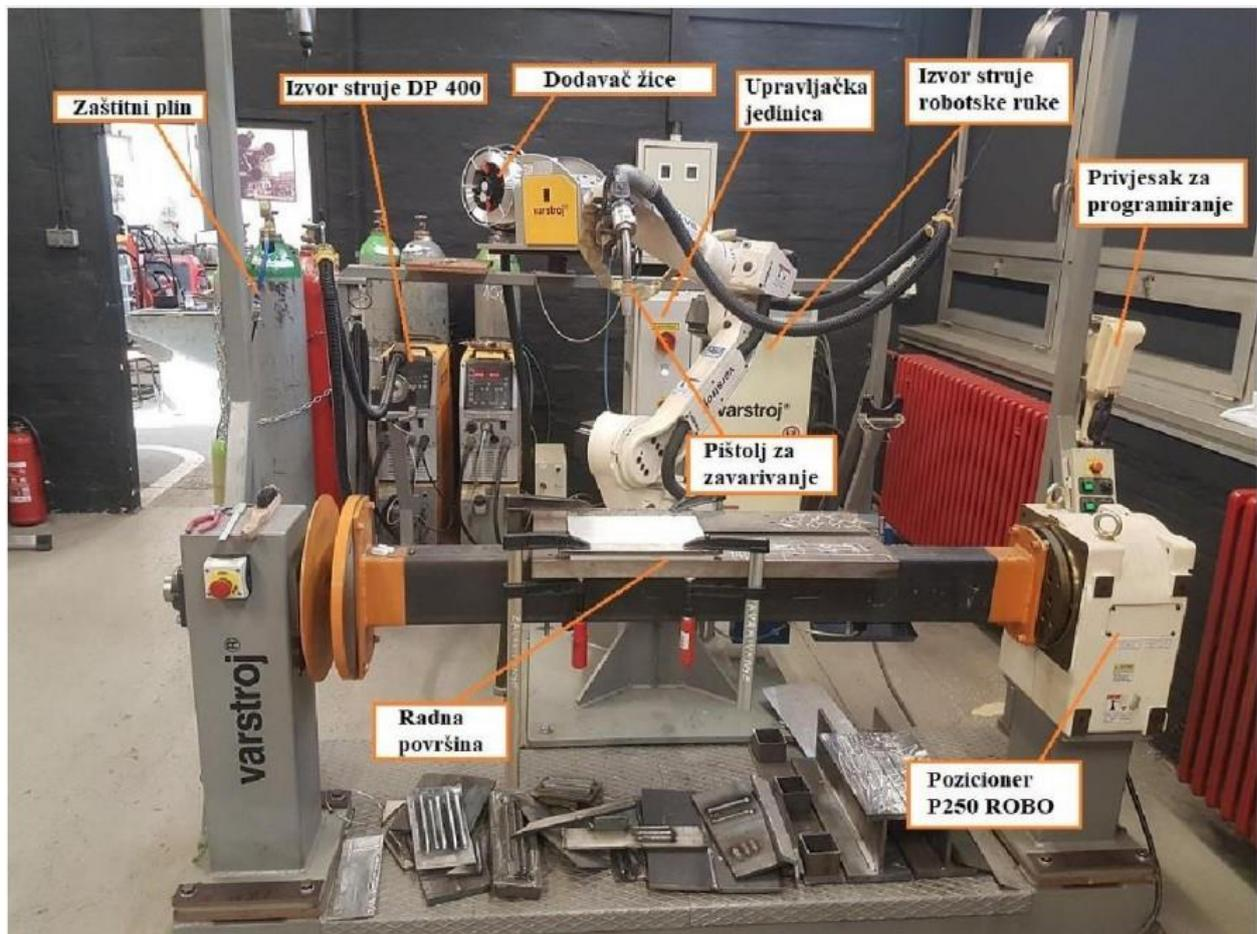
Slika 25. Robotska stanica Almega OTC AX V6 [12]
