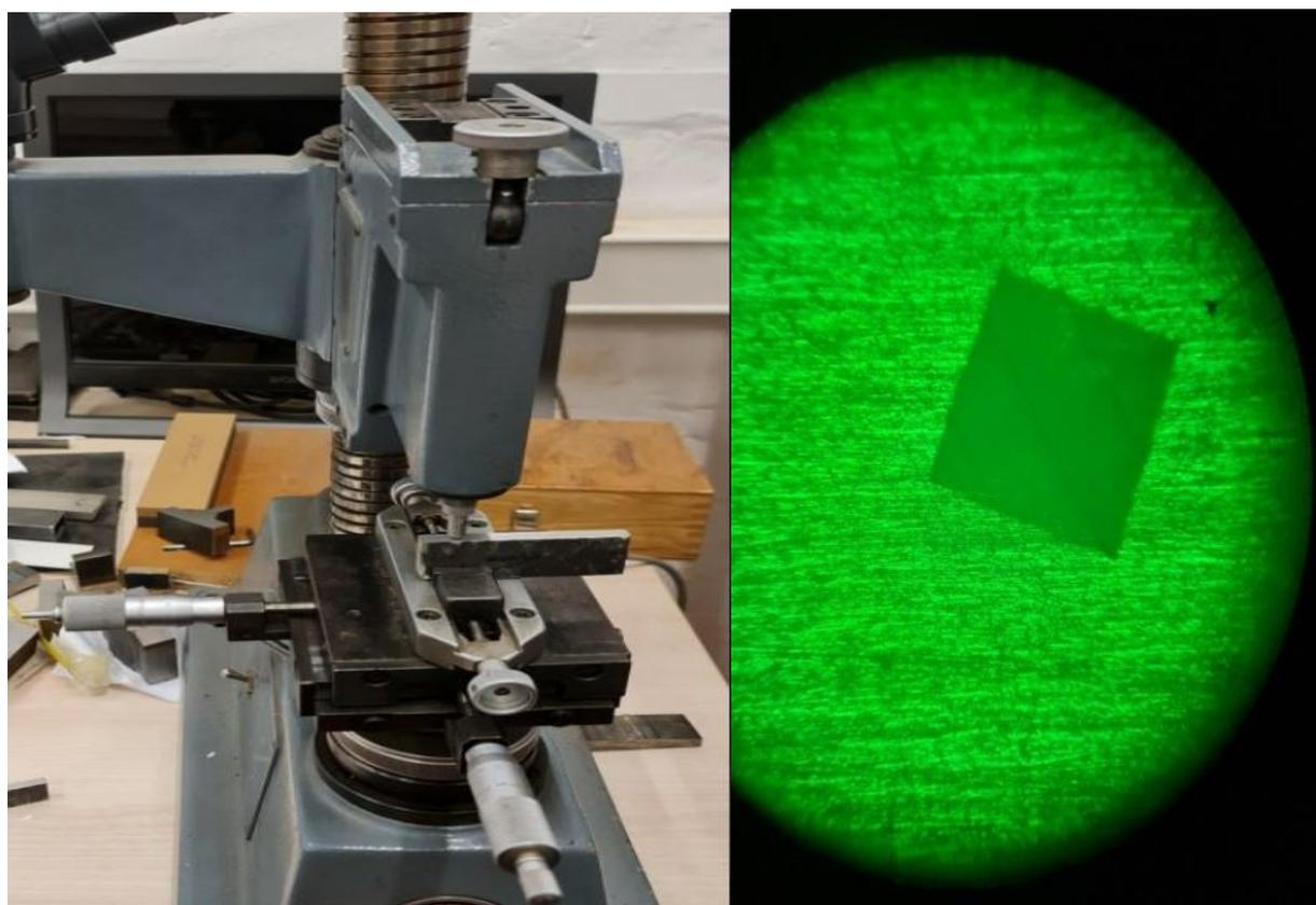
Slika 45. Princip i uređaj za mjerenje tvrdoće HV 10
