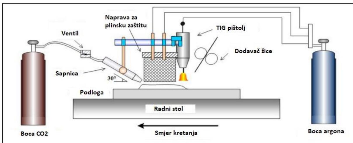
Slika 1. Shematski prikaz TIG WAAM sustava [1]
