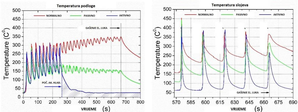
Slika 9. Primjer toplinskog ciklusa dobivenog mjerenjem temperature u istoj točki predforme i podloge [7]
