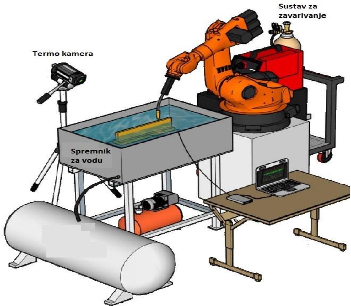
Slika 6. Eksperimentalna oprema za testiranje principa aktivnog hlađenja [7]
