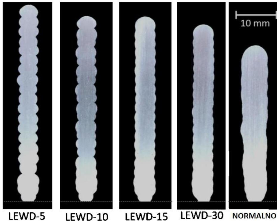
Slika 18. Utjecaj LEWD-a na izgled poprečnog presjeka predforme [7]
