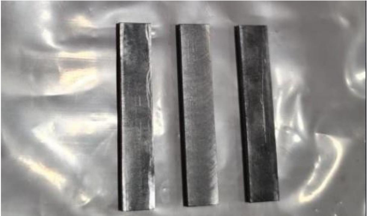
Slika 43. Gotovi uzorci, spremni za izradu V-utora
