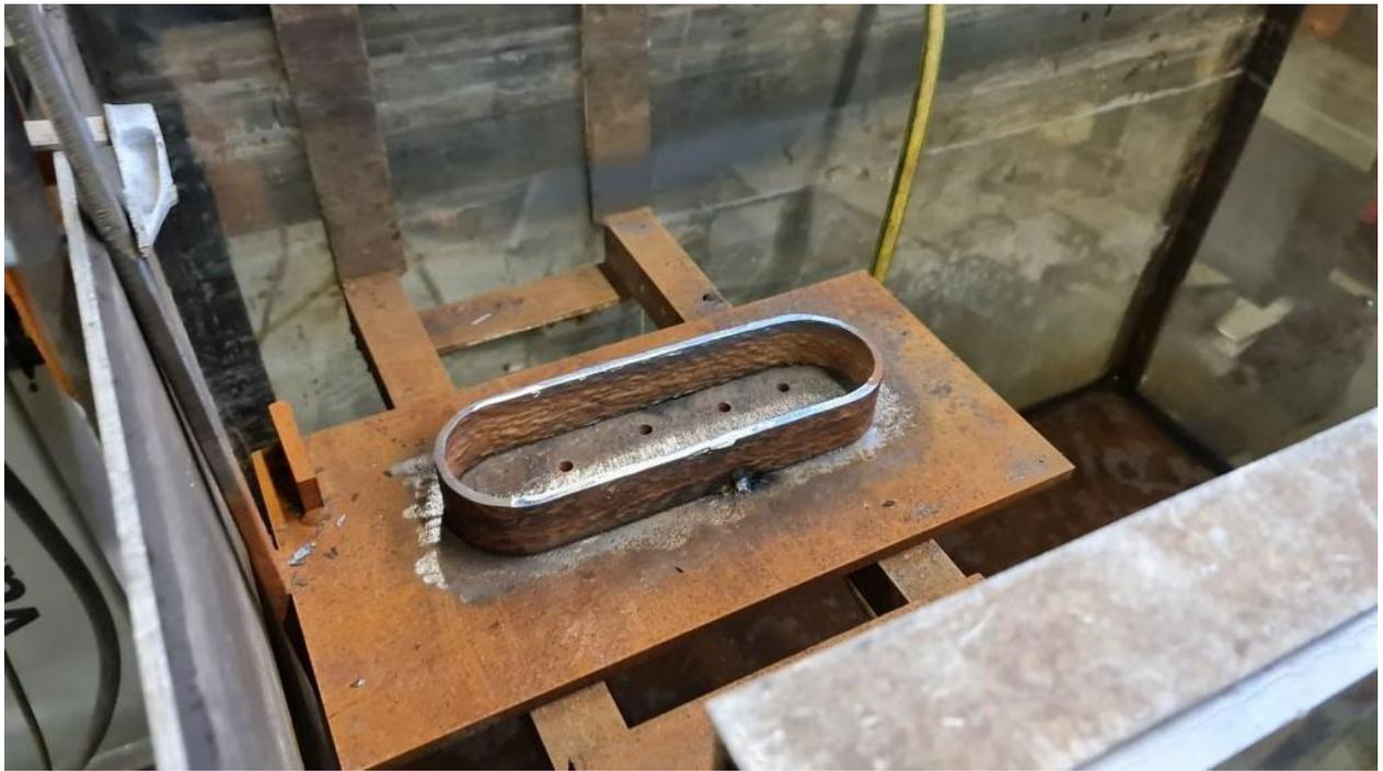
Slika 34. Poligon (podloga) za taloženje predforme
