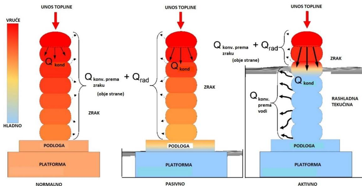
Slika 5. Shema koncepta aktivnog hlađenja u usporedbi s normalnim i pasivnim načinom hlađenja;  $Q_{kond}$  predstavlja odvođenje topline kondukcijom dok  $Q_{konv}$  predstavlja odvođenje topline konvekcijom [8]
