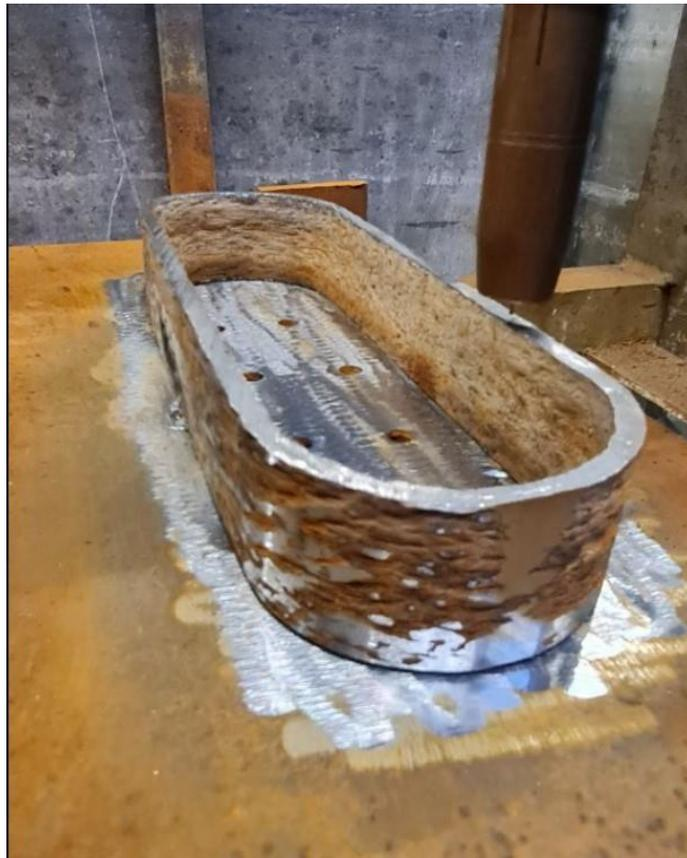
Slika 30. Poligon (podloga) za taloženje predforme
