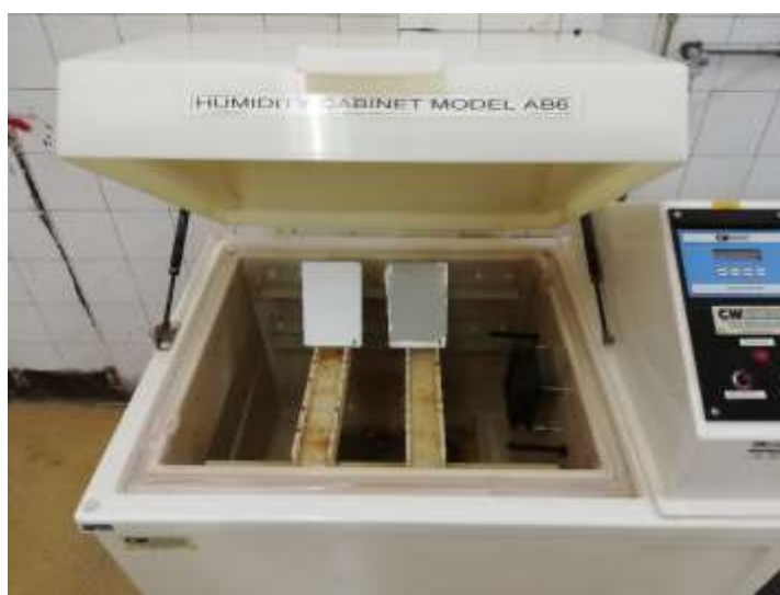
Slika 32. Uzorci 4 i 6 u vlažnoj komori
