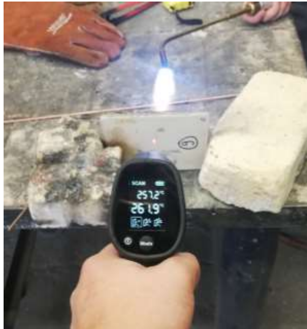
Slika 43. Mjerenje temperature stražnje strane ispitnog uzorka tijekom provođenja eksperimenta
