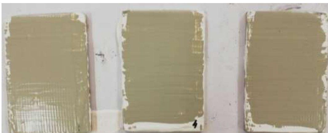
Slika 31. Uzorci premazani poliuretanskim premazom
