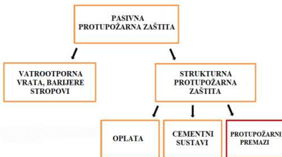
Slika 7. Shematski prikaz pasivne protupožarne zaštite [18]
