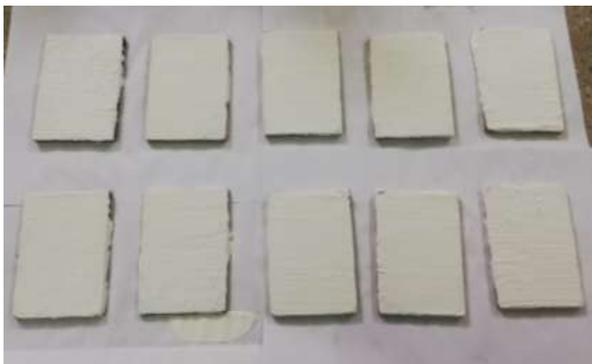
Slika 29. Prikaz svih deset ispitnih uzorka nakon nanesenog drugog sloja premaza
