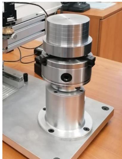
Slika 12. Rotacijska os sustava za beskontaktno mjerjenje
