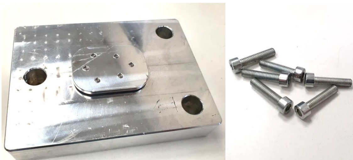
Slika 7.25. Sklapanje gornje ploče kalupa s jezgrom
