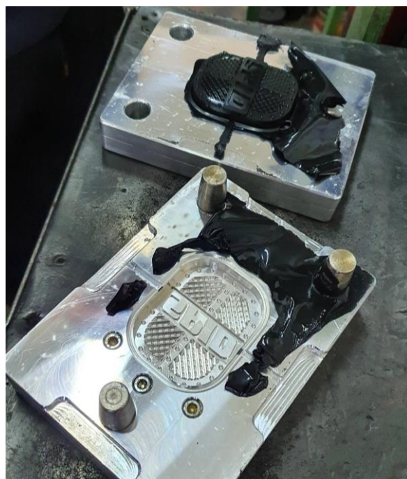
Slika 7.29. Otvaranje kalupa, nakon prešanja
