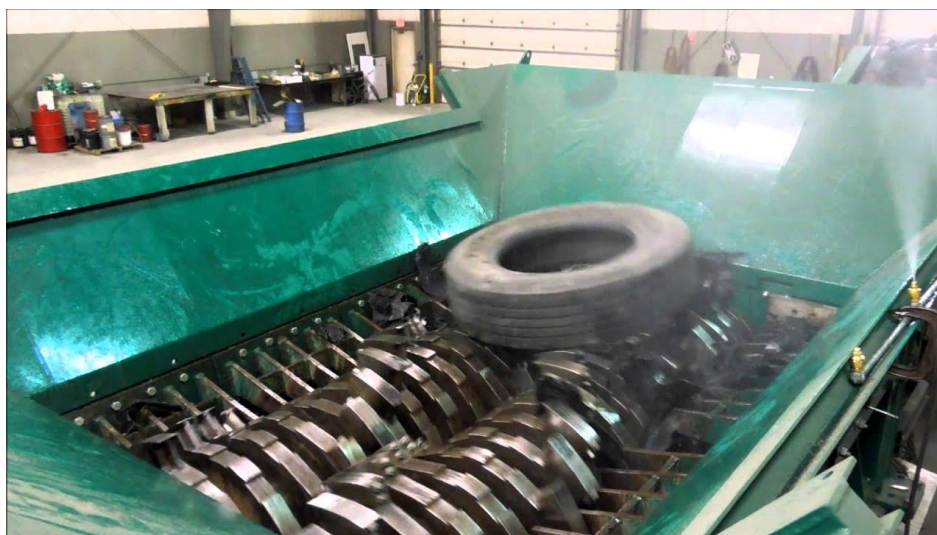
Slika 6.2. Stroj za komadanje pneumatika [27]
