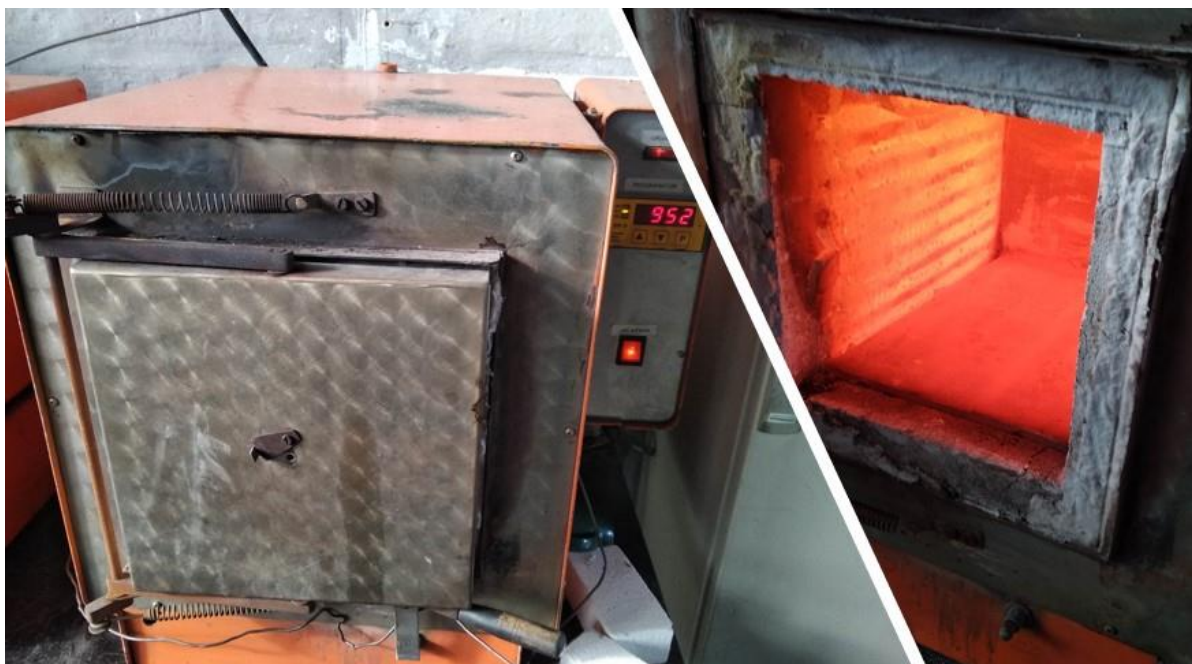
Slika 19. Prikazuje peć prethodno ugrijanu na temperaturu boriranja
