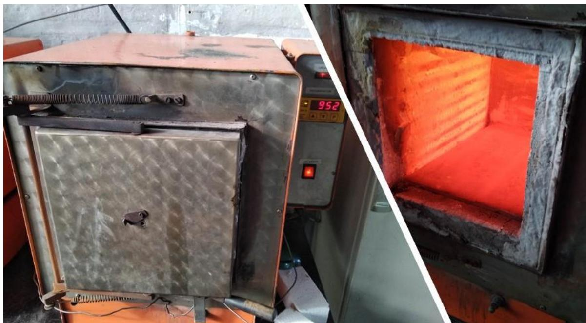
Slika 19. Prikazuje peć prethodno ugrijanu na temperaturu boriranja
