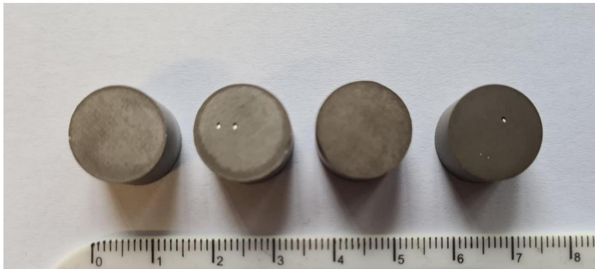
Slika 21. Uzorci nakon boriranja i dubokog boriranja
