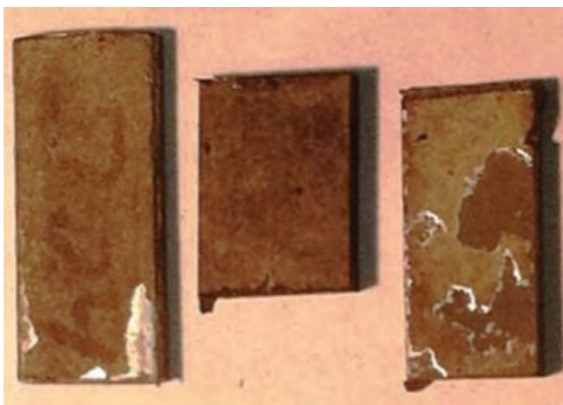
Slika 11. Pojava ljuštenja na različitim vrstama čelika [14]
