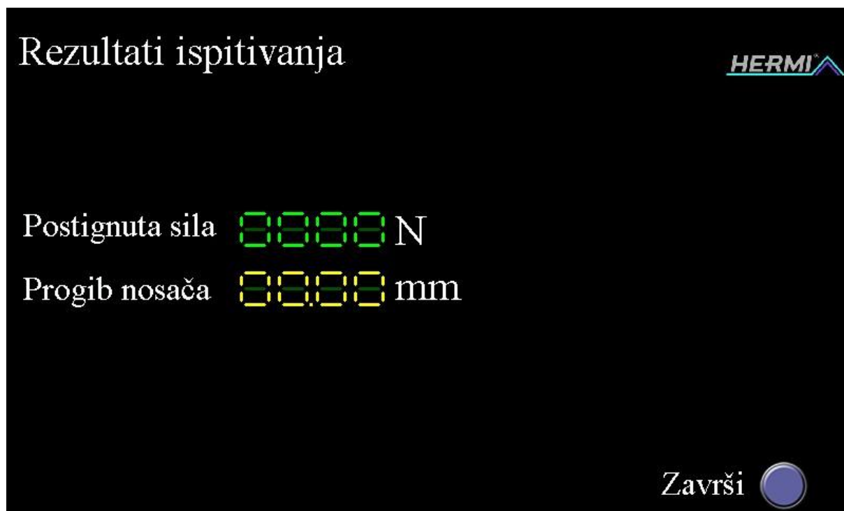
Slika 40. Rezultati ispitivanja nosača
