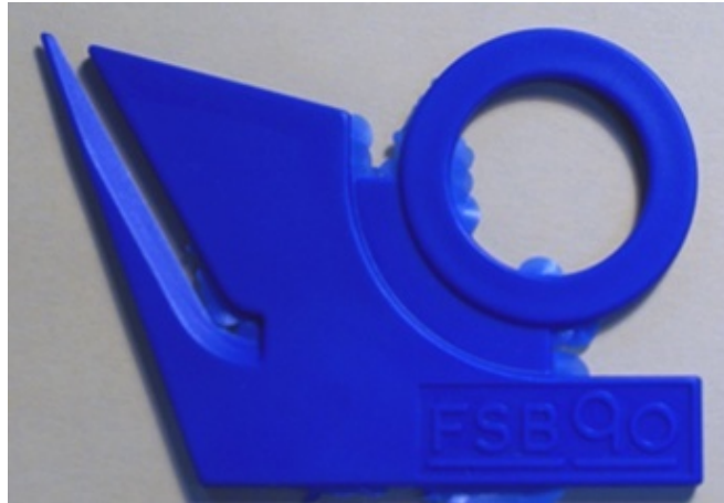
Slika 3.1 Otpresak sa srhom
