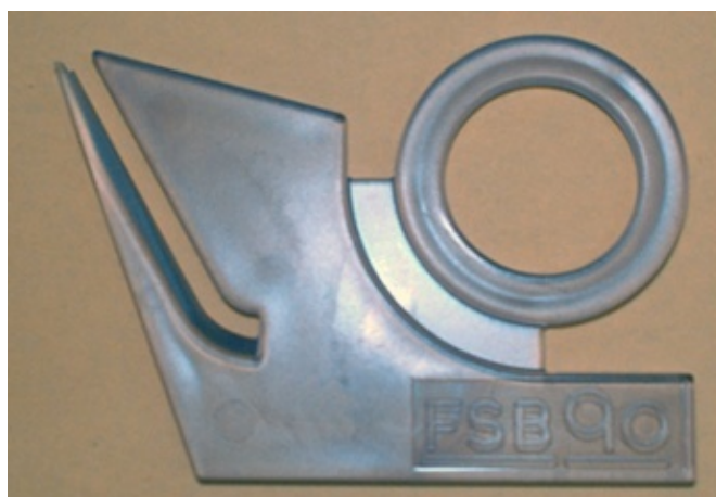
Slika 3.8 Otpresak sa vidljivim otiskom izbacivala
