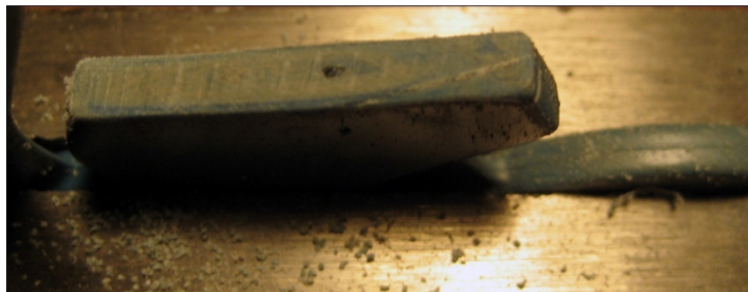
Slika 5.3 Presjek nepotpunog otpresaka na mjestu tamne mrlje na radiogramu
