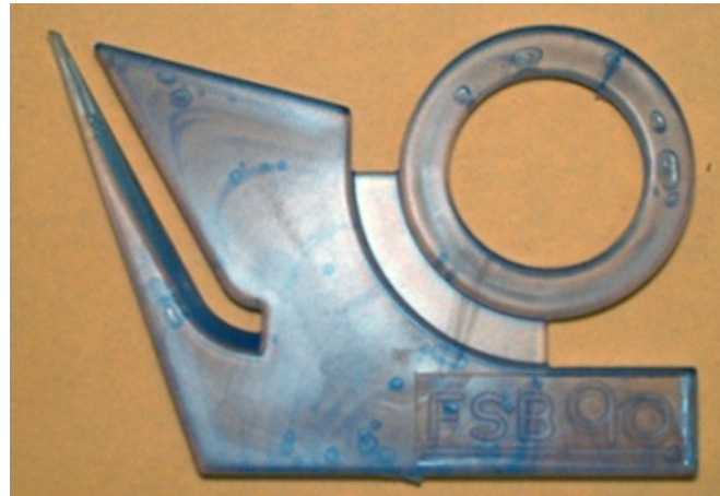
Slika 3.5 Otpresak sa mjehurićima zraka
