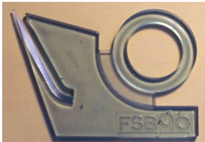
Slika 3.6 Otpresak sa uključenim česticama metala
