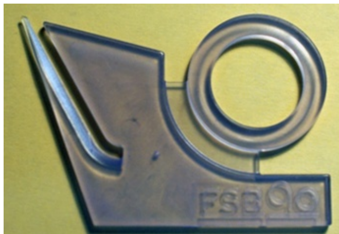
Slika 3.3 Otpresak sa uleknućima na površini
