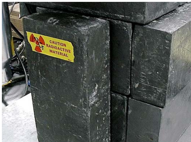
Slika 6.7 Olovna zaštita od zračenja [13]
