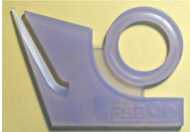
Slika 3.10 Otpresak sa veličinom stezanja iznad dozvoljenog maksimuma
