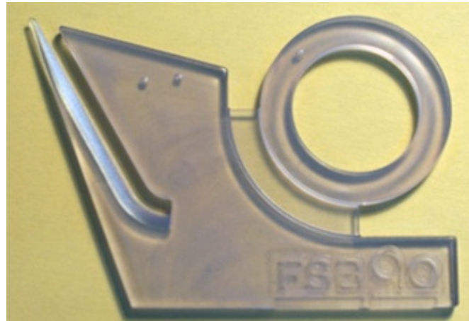
Slika 3.4 Otpresak sa podtlačni mjehurićima
