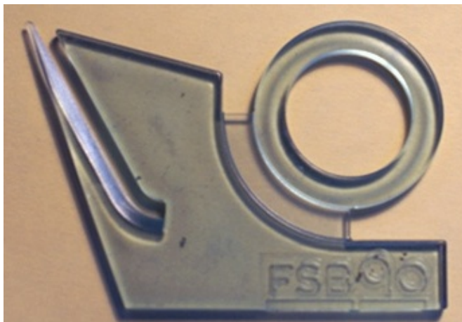
Slika 3.6 Otpresak sa uključenim česticama metala
