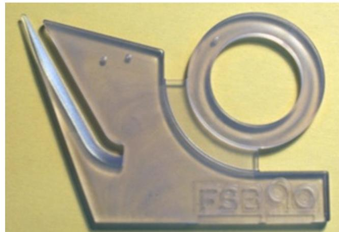
**Slika 3.4 Otpresak sa podtlačni mjeđurićima**
