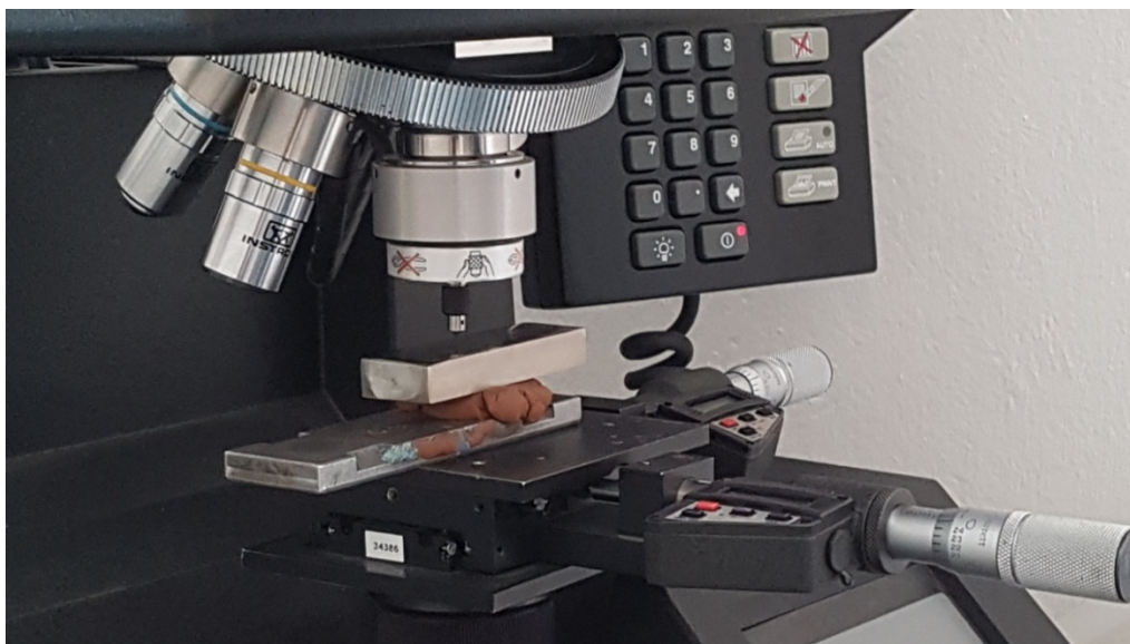
Slika 27. Uzorak postavljen na mikrotvrdomjer
