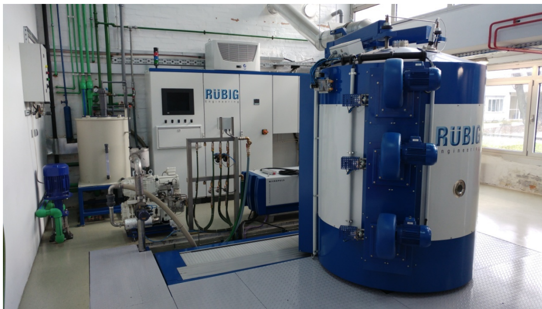
Slika 21. Uredaj za nitriranje u plazmi Rübiger Micropuls PC 70/90
