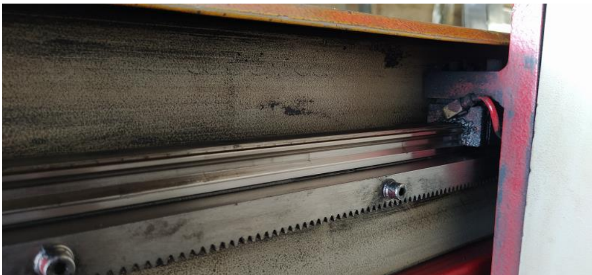
Slika 25. Vodilica i klizači CNC plazma stroja
