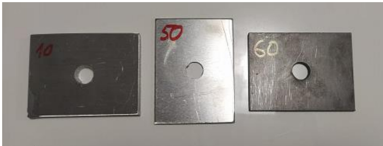
Slika 36. Izrezani i obrušeni ispitni uzorci
