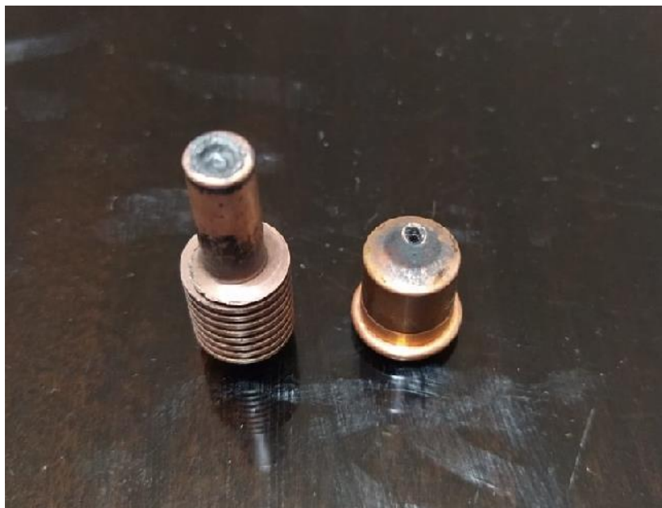
Slika 19. Uništena elektroda i sapnica
