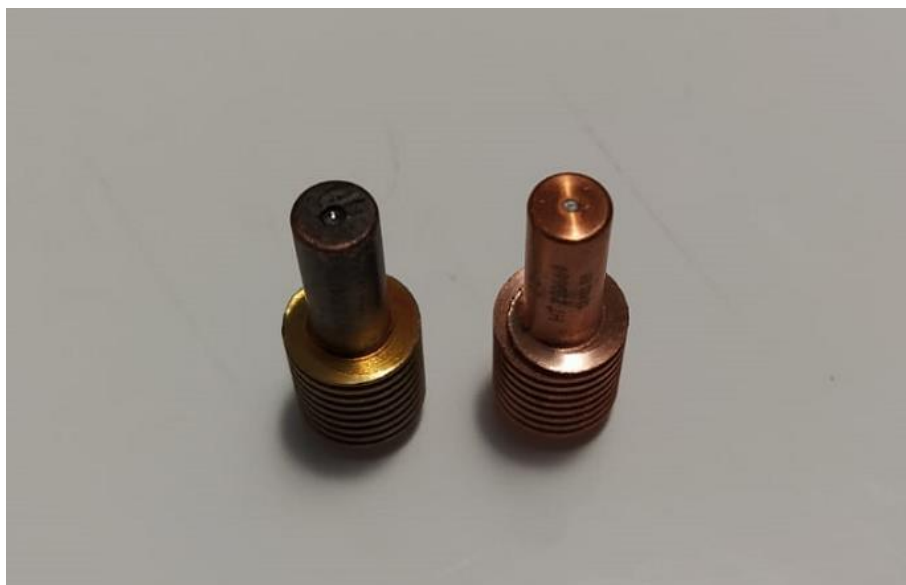
Slika 17. Djelomično potrošena elektroda (lijevo) i nova elektroda (desno)
