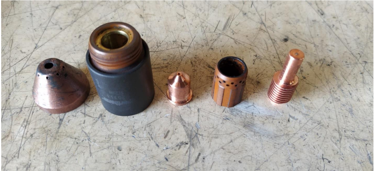
Slika 33. Potrošni dijelovi vrha gorionika Hypertherm T45m
