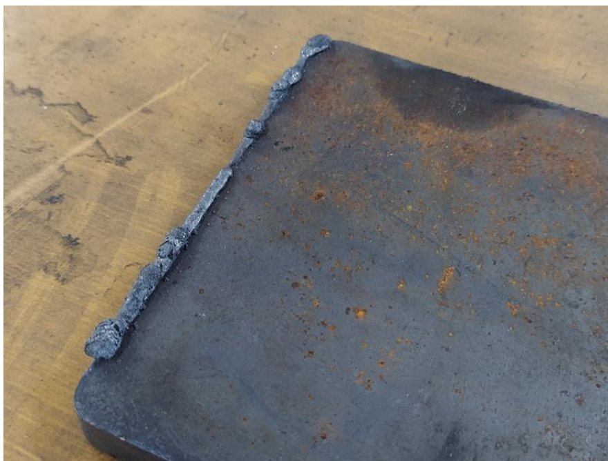
Slika 9. Akumulacija troske s donje strane izrezanog komada uslijed premale brzine
