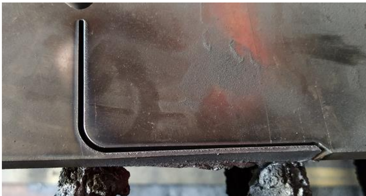
Slika 16. Iniciranje rezanja na rubu ploče
