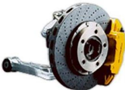
**Slika 2.5. Kočni disk od kompozita sa SiC matricom ojačan ugljičnim vlaknima [10]**
