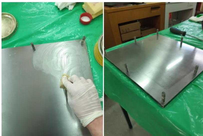
**Slika 5.2. Nanošenje odvajala i poliranje kalupa**
