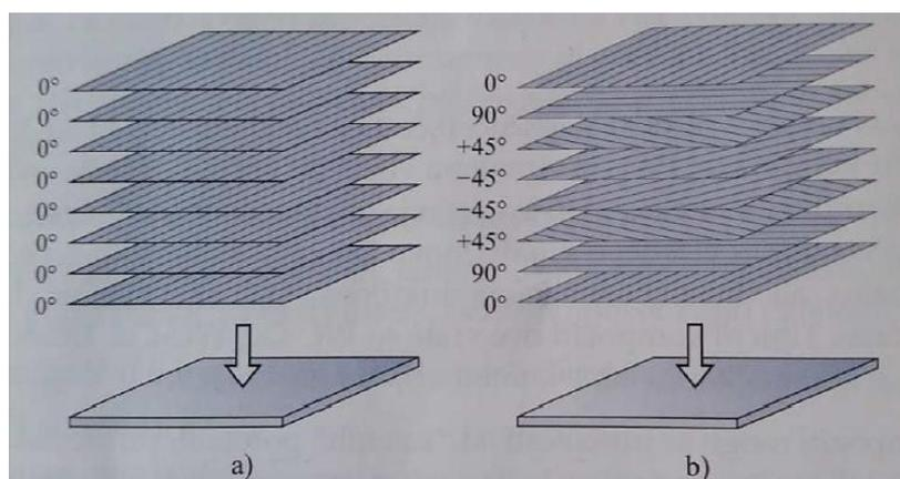
**Slika 2.17. Struktura laminata s različitim smjerovima polaganja vlakna u slojevima; a) jednosmjerno polaganje; b) višesmjerno polaganje [30]**
