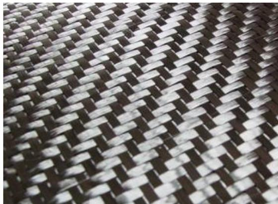
**Slika 2.15. Ugljična vlakna [27]**
