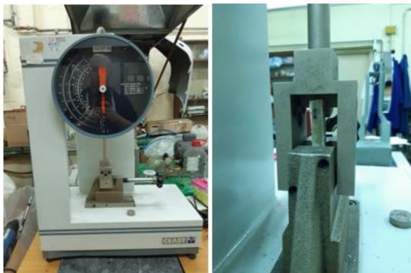
**Slika 5.16. Uređaj za ispitivanje žilavosti po Izodu**
