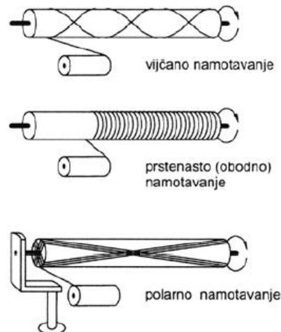
**Slika 2.22. Prikaz vijčanog, prstenastog (obodnog) i polarnog namotavanja [14]**
