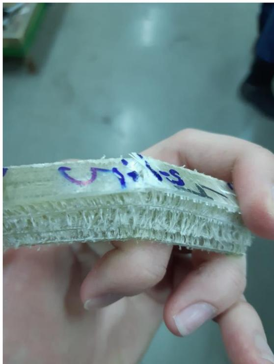
Slika 5.18. Ispitni tijelo Ž-5-3 nakon ispitivanja žilavosti
