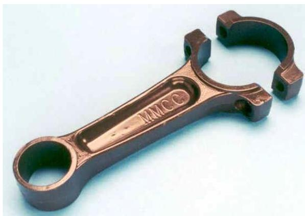
Slika 2.4. Klipnjača s Al matricom ojačana  $Al_2O_3$  česticama [10]
