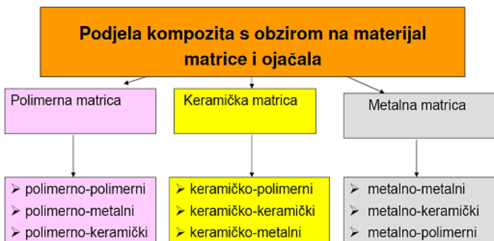
Slika 2.2. Podjela kompozita s obzirom na materijal matrice i ojačavala [7]
