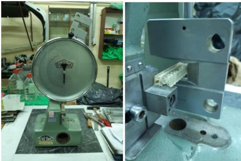
Slika 5.15. Uređaj za ispitivanje žilavosti po Charpyu
