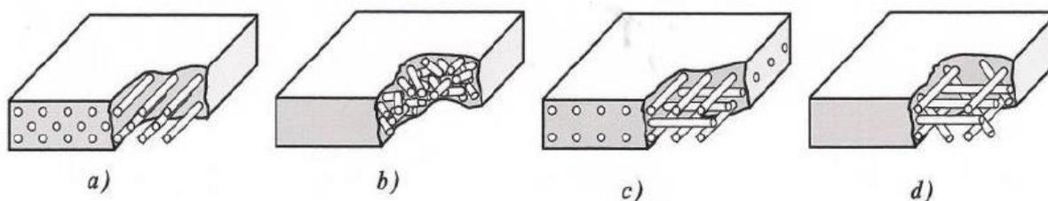
**Slika 2.8. Različiti načini rasporeda vlaknastih ojačavala: a) kontinuirana jednosmjerna vlakna, b) slučajno usmjerena diskontinuirana vlakna, c) ortogonalno raspoređena vlakna, d) višesmjerno usmjerena vlakna [8]**
