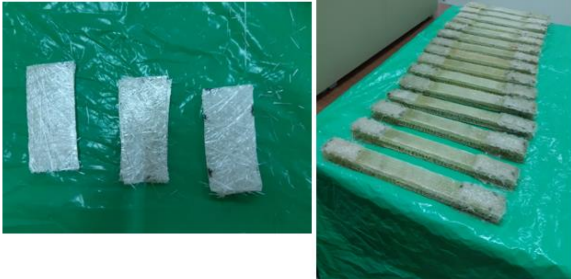
Slika 5.7. Dodavanje end tabova na krajeve ispitnih tijela za ispitivanje rasteznih svojstava
