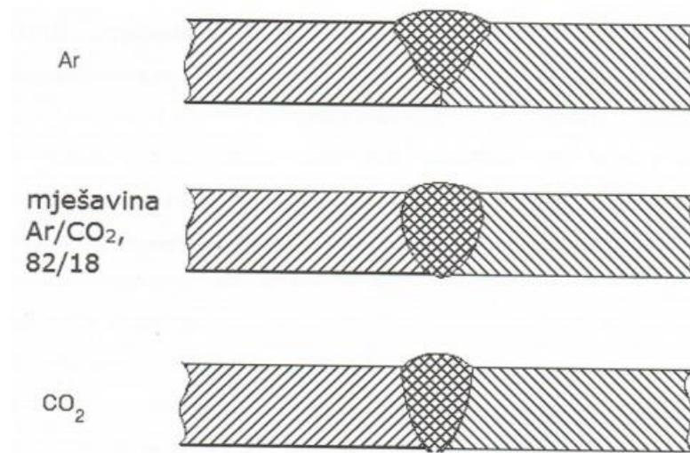
Slika 5. Profil zavarenog spoja ovisno o zaštitnom plinu [1]
