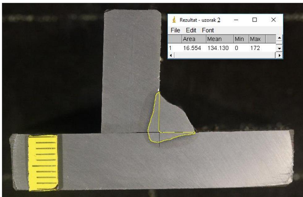
Slika 44. Analiza bočne penetracije koristeći alat *ImageJ* na uzorku 2
