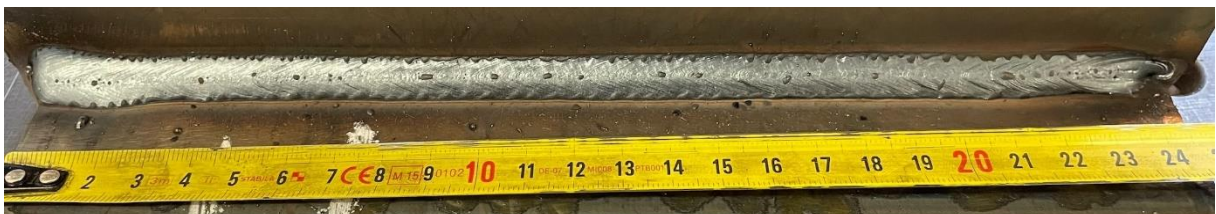
Slika 31. Izgled zavara uzorka 4
