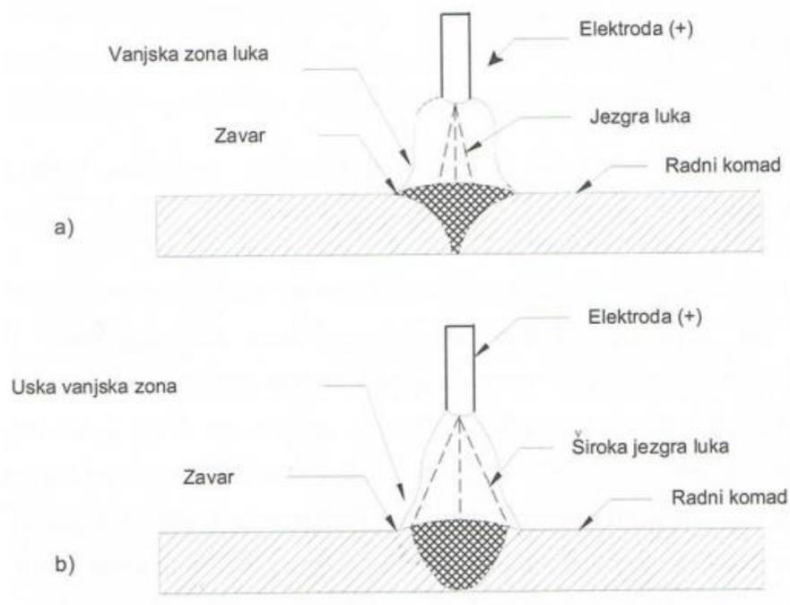
Slika 4. Karakterističan oblik i geometrija električnog luka i zavarenog spoja [1]:
