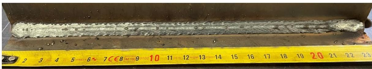
Slika 29. Izgled zavara uzorka 2
