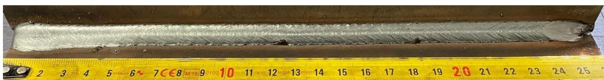
Slika 30. Izgled zavara uzorka 3
