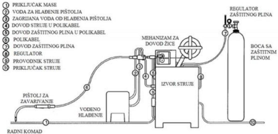
Slika 2. Shematski prikaz opreme za MAG zavarivanje [3]
