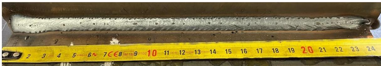
Slika 31. Izgled zavara uzorka 4
