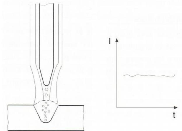
Slika 19. Prikaz prijenosa metala štrcajućim lukom kod MAG postupka zavarivanja [1]
