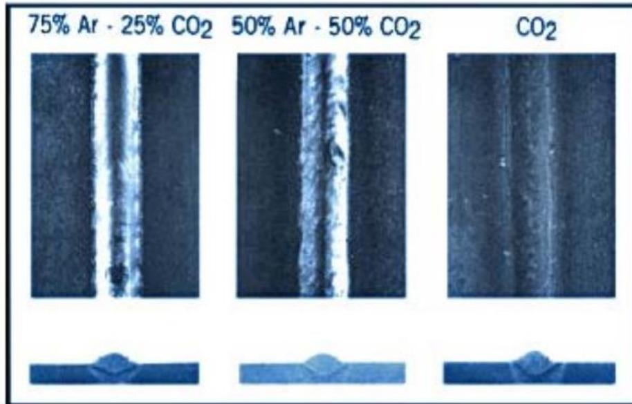
Slika 9. Utjecaj dodavanja CO<sub>2</sub> argonu na izgled zavara [6]
