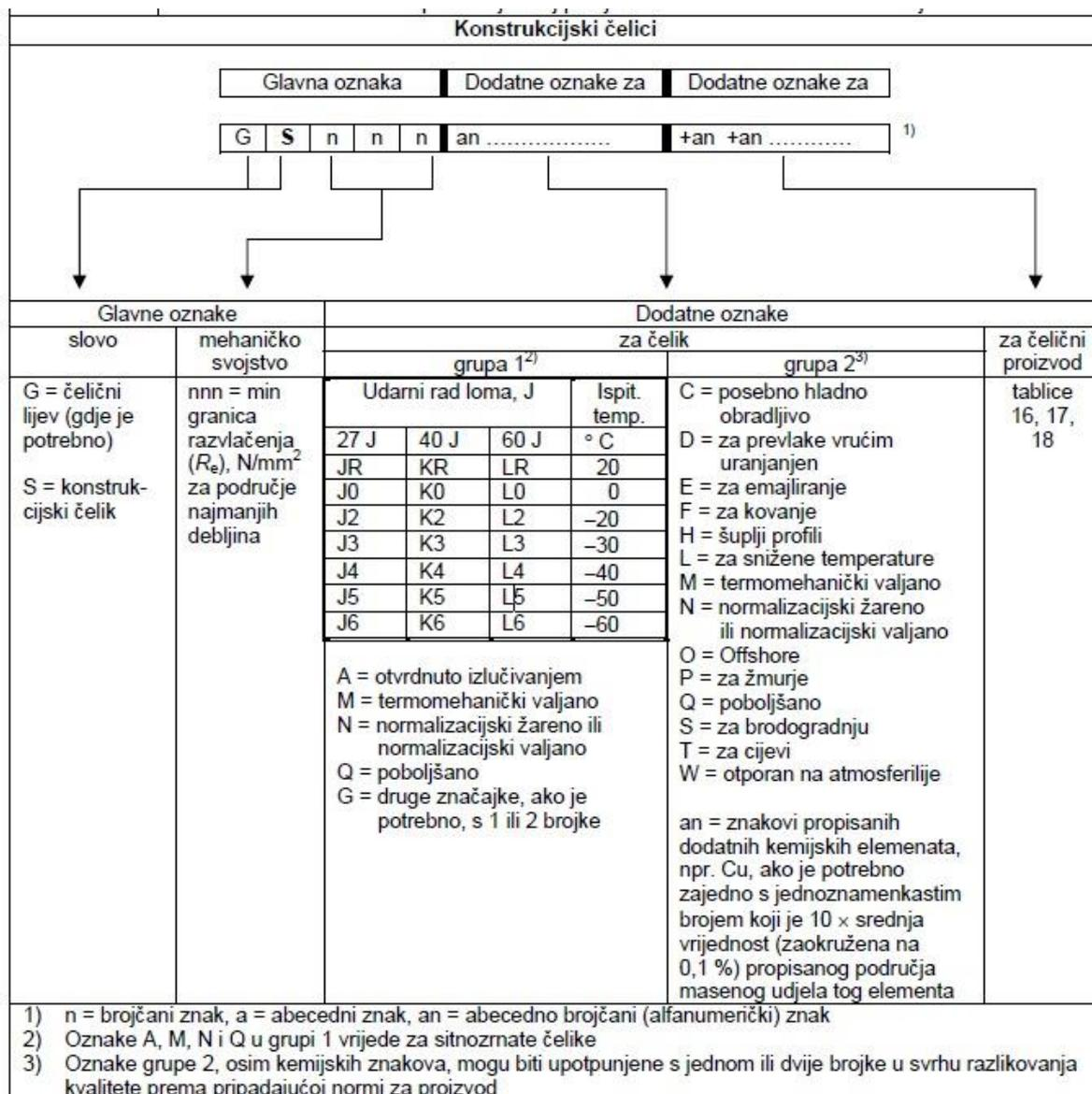
Slika 22. Shema za označavanje konstrukcijskih čelika [17]
