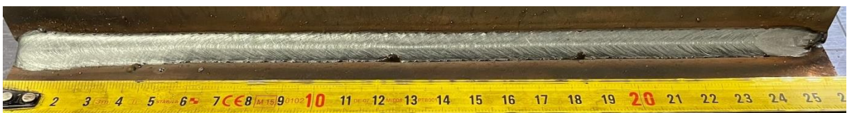
Slika 30. Izgled zavara uzorka 3
