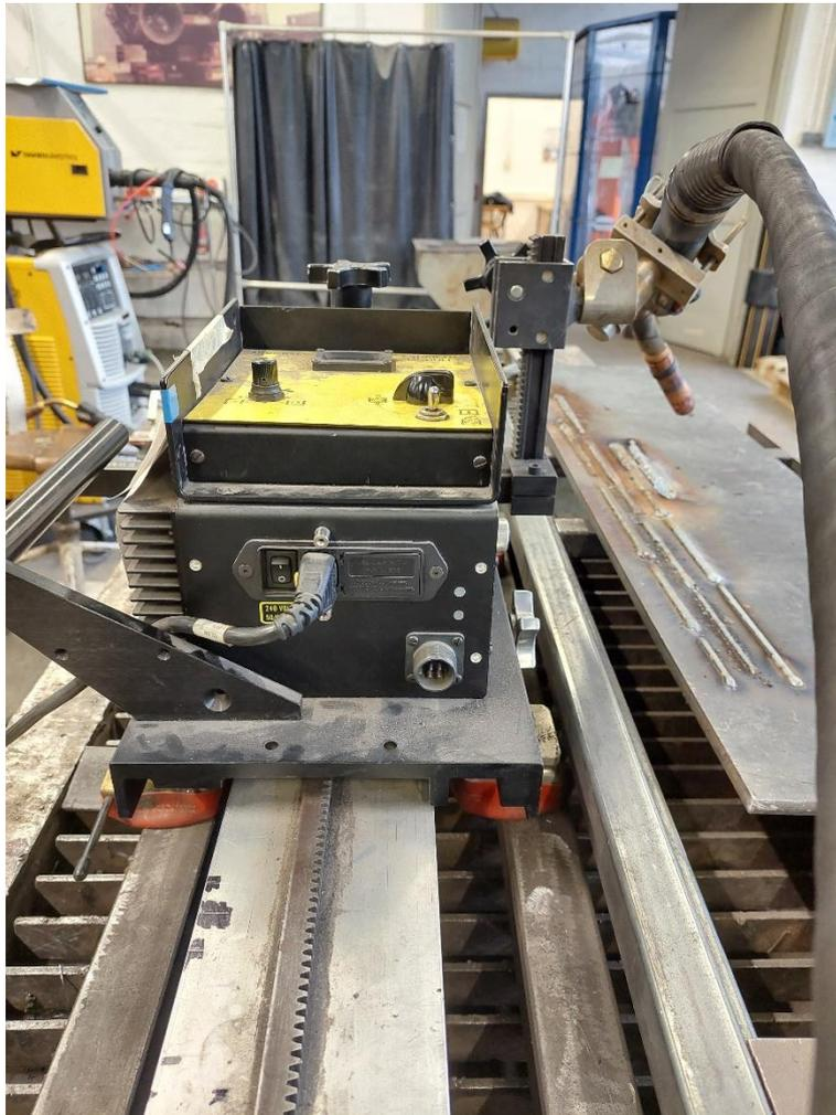
Slika 25. Uređaj za vođenje pištolja "BUG - O MDS 1002"
