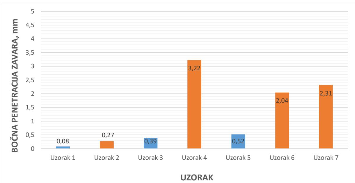
Slika 51. Dijagram usporedbe analiziranih dubina penetracije zavara ispitanih uzoraka
