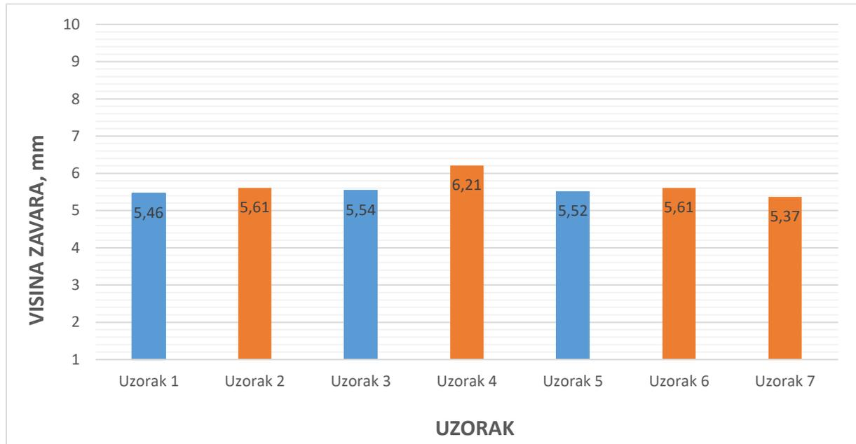
Slika 47. Dijagram usporedbe analiziranih visina zavara ispitanih uzoraka
