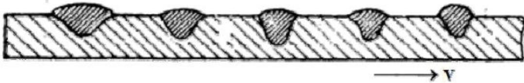
Slika 16. Utjecaj brzine zavarivanja na geometriju zavara [14]
