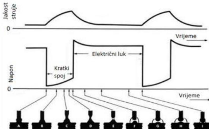
Slika 18. Prikaz prijenosa metala kratkim spojevima po fazama [16]
