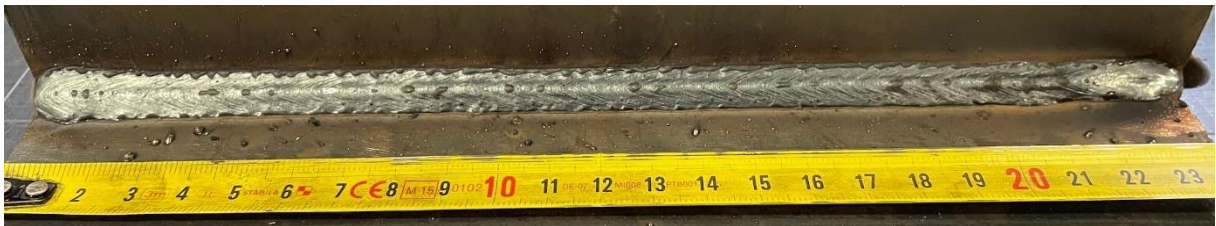
Slika 29. Izgled zavara uzorka 2
