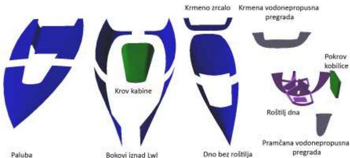
Slika 5.5. Konstruktivni djelovi
