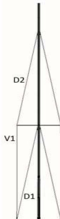
Pripone su za hvatišta pripona spojene uz pomoć pločice od nehrđajučeg čelika debljine 10mm, a za hvatište spojene uz pomoć 6 vida debljine 6mm. Promjer uške za koje se hvataju pripone je 14mm. Leto i zaputka se za trup spajaju također uz pomoć pločica nehrđajučeg čelika debljine 10mm.
