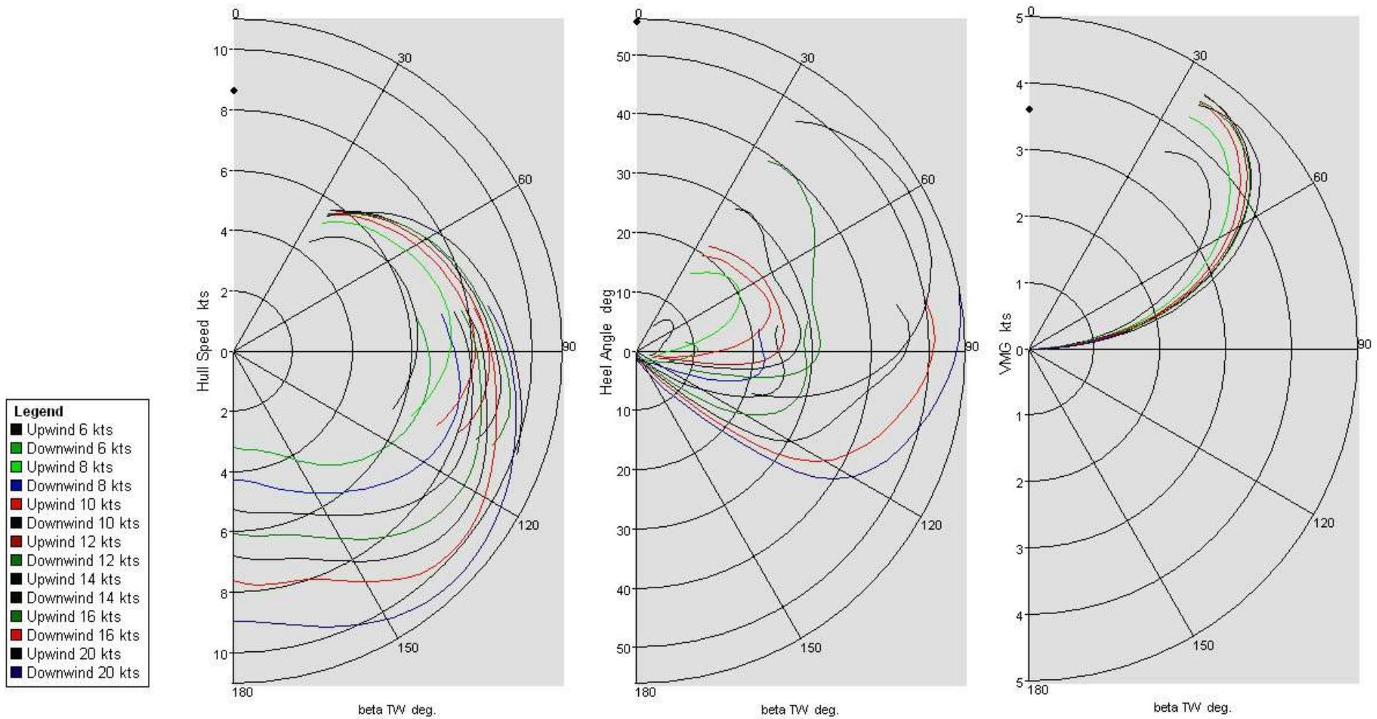
Dijagram 8.1. Polarni dijagrami generirani programom SPAN
