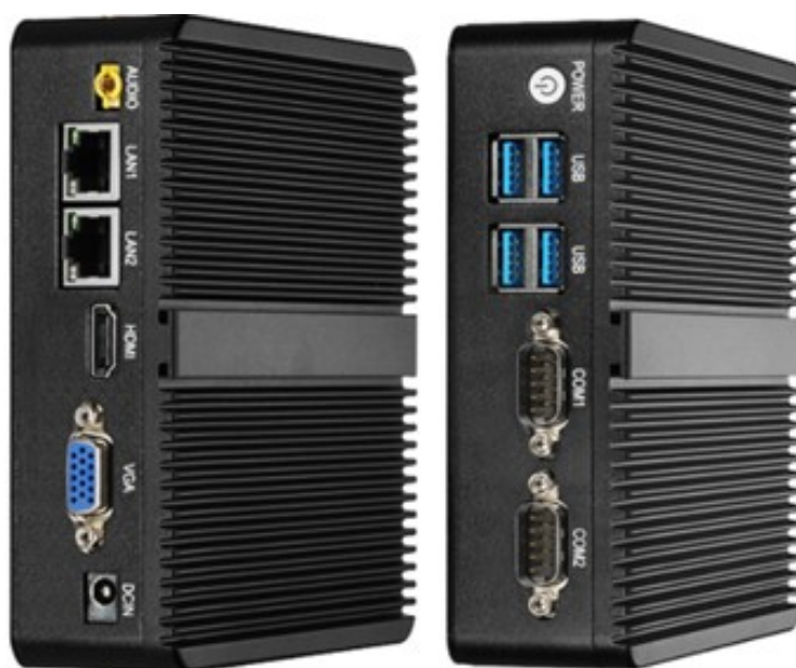
Slika 6-14. Industrijsko računalo XCY X30 J1900 [30]
