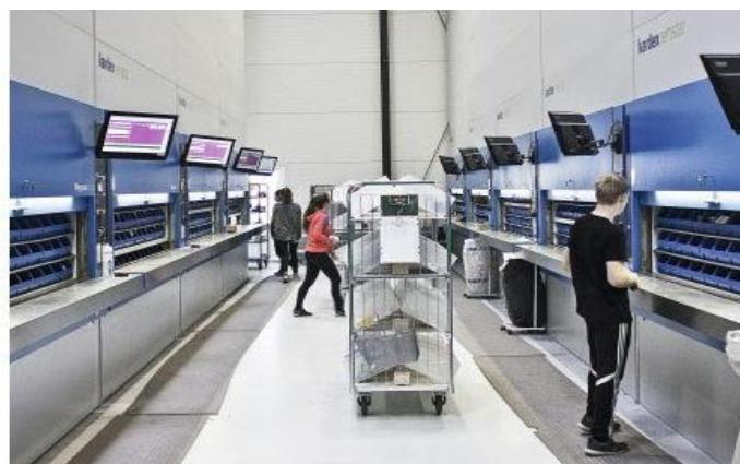
**Slika 40. Neki od sustava vertikalnih karusela [27]**
