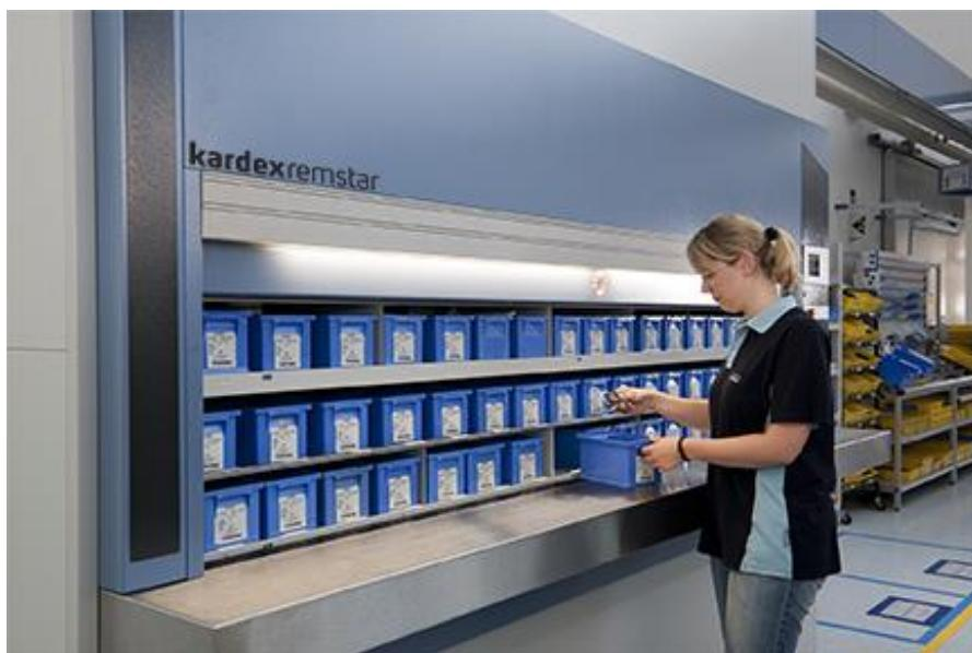
Slika 37. Primjer vertikalnog karusela [25]
