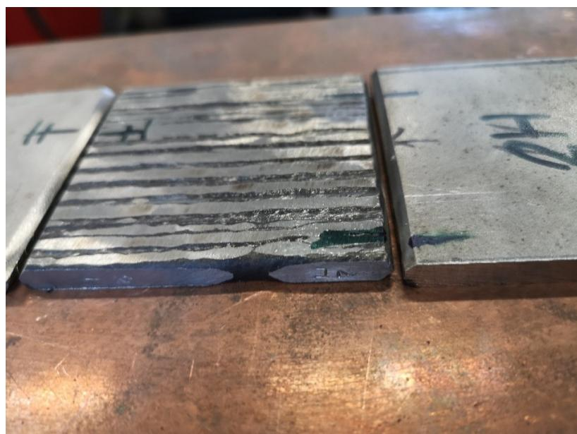
**Slika 49. Priprema za navarivanje dodatka okomito na smjer izrade (2H)**
