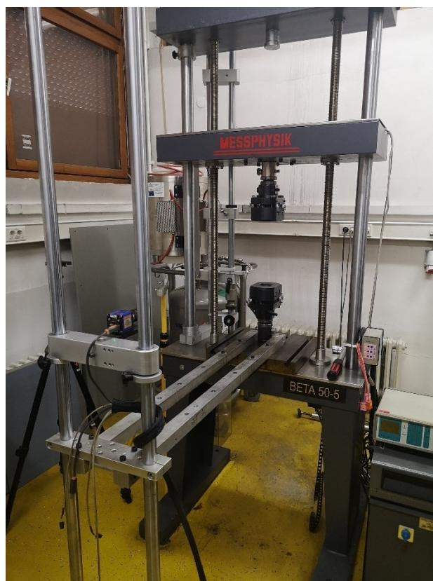
**Slika 62. Kidalica MESSPHYSIK BETA 50-5 sa optičkim ekstenziometrom**
