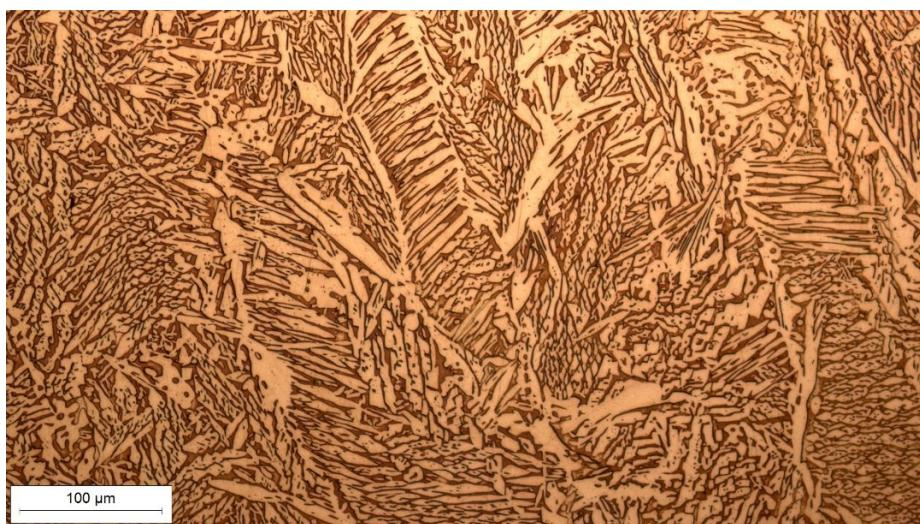
Slika 81. Mikrostruktura nakon homogenizacijskog žarenja, povećanje 200x
