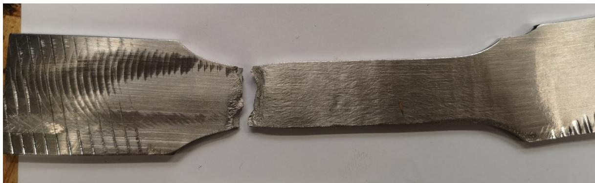
**Slika 52.** Puknuće epruvete 2V na mjestu zavara
