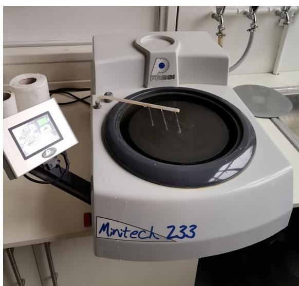
Slika 38. Uredaj za brušenje i poliranje uzorka Minitech 233
