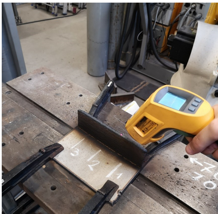
Slika 55. Mjerenje međuprolazne temperature sa jasno vidljivim mjestima mjerenja visine zida
