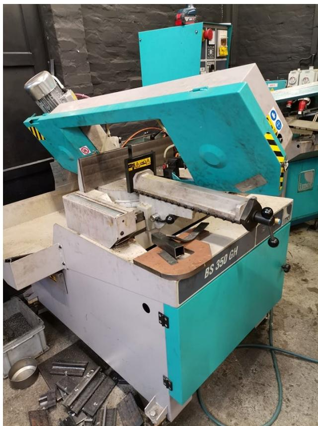
Slika 27. Tračna pila korištena za rezanje zida
