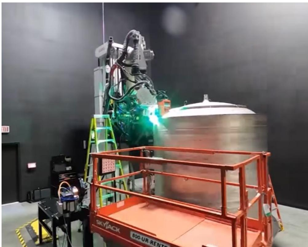
Slika 4. Izrada TerranR rakete WAAM postupkom AM [9]
