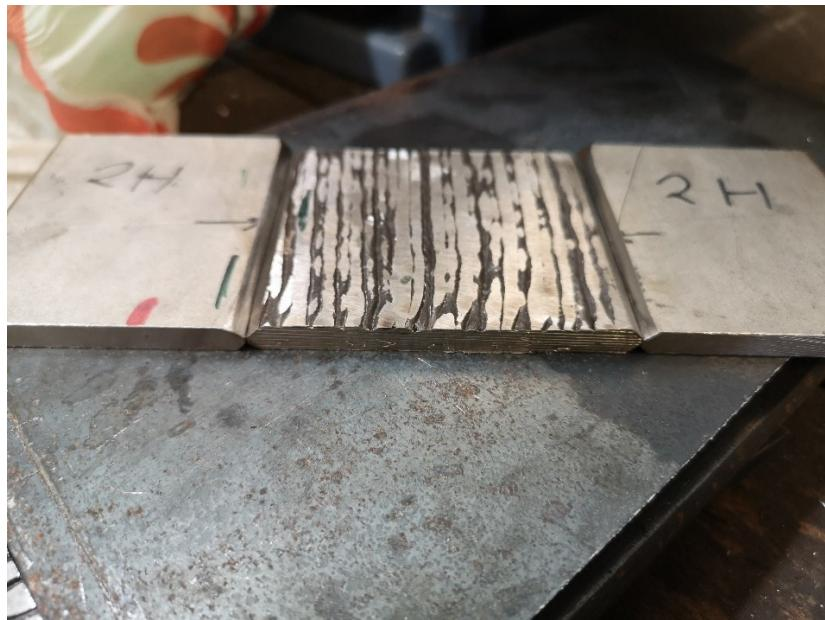
**Slika 50. Priprema za navarivanje dodataka u smjeru izrade (2V)**
