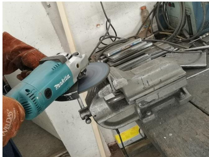
**Slika 48. Priprema zida za zavarivanje**
