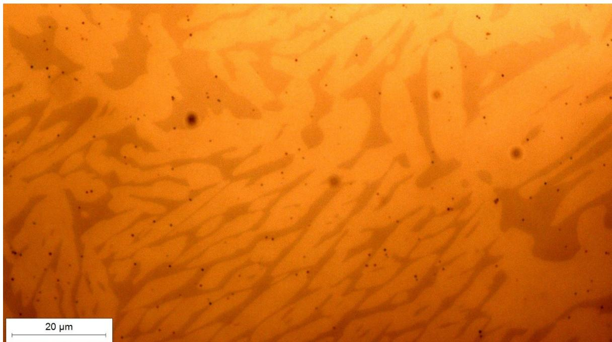
**Slika 45. Mikrostruktura nakon elektrolitičkog nagrizanja oksalnom kiselinom, povećanje 1000x (B3T)**
