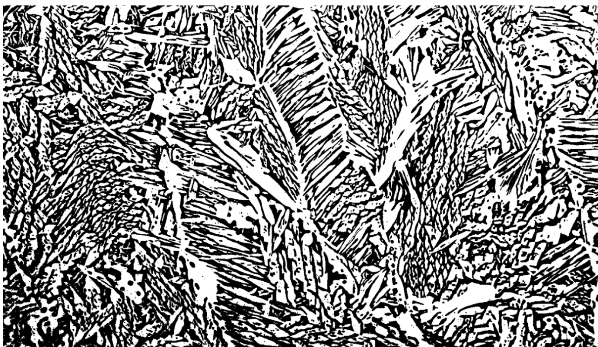
Slika 86. Računalno dorađena slika korištena za izračun udjela ferita, nakon toplinske obrade, povećanje 200x (B3T)
