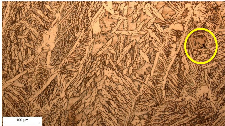
Slika 80. Mikrostruktura prije homogenizacijskog žarenja, povećanje 200x
