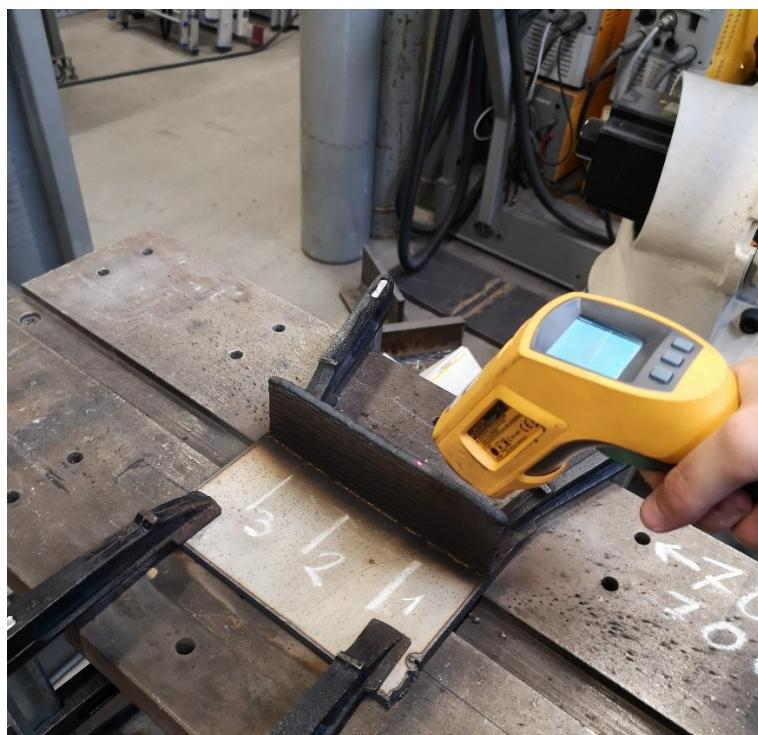
**Slika 55. Mjerjenje međuprolazne temperature sa jasno vidljivim mjestima mjerena visine zida**
