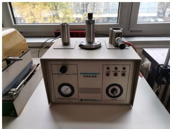
Slika 37. Uredaj za zalijevanje uzorka u masu
