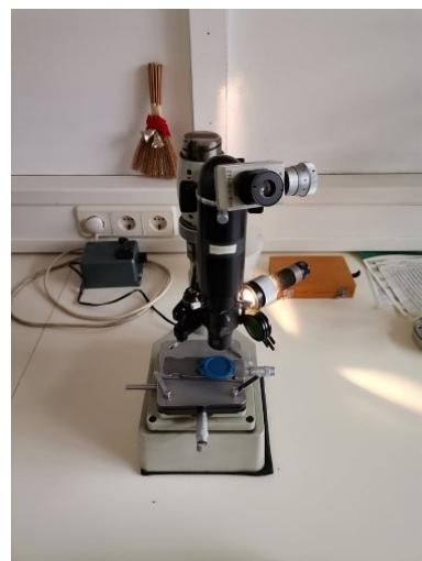
Slika 42. Mikrotvrdomjer PMT-3 korišten u eksperimentu
