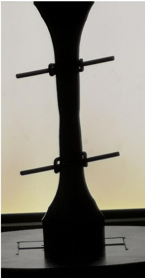
Slika 66. Vidljivo nastanje vrata na epruveti
