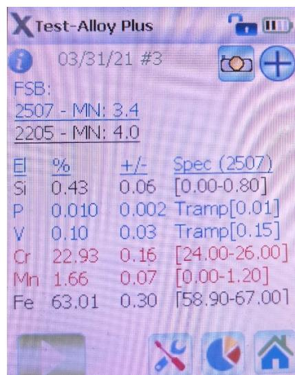
**Slika 34. Prikaz rezultata mjerjenja XRF uređajem**
