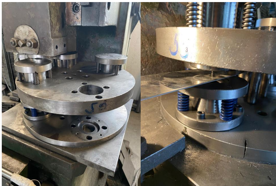
Slika 48. Rotacijski stol s alatima za probijanje i provlačenje
