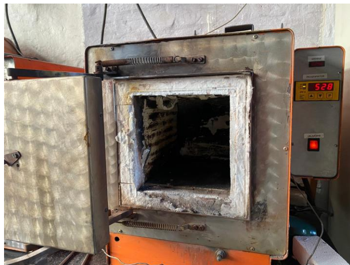
Slika 43. Peć za popuštanje čelika (525 °C; 180 °C)
