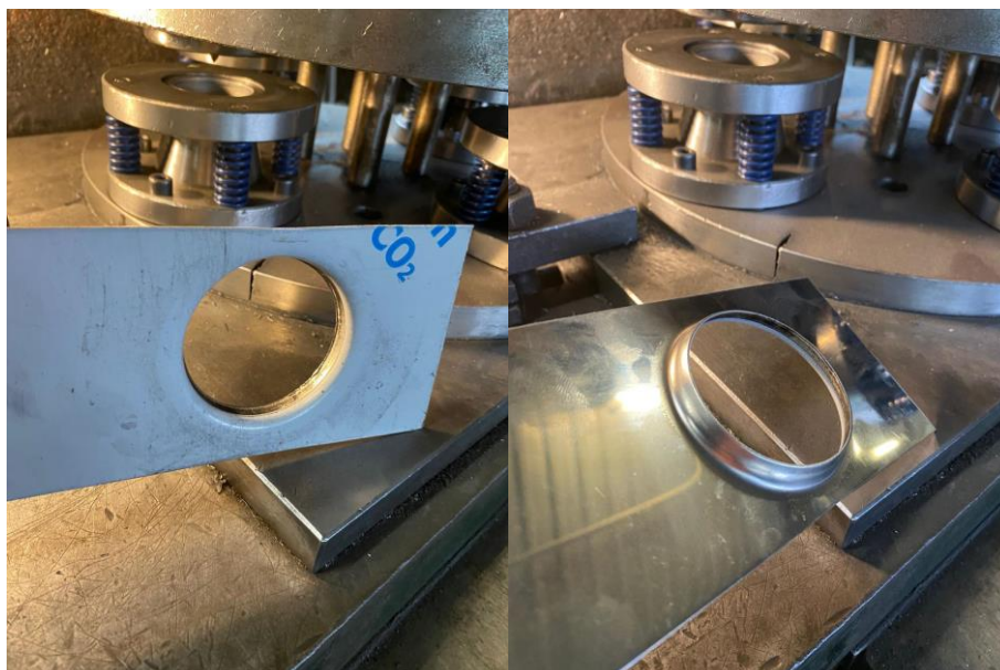
Slika 49. Izgled lima nakon probijanja izrađenim alatom
