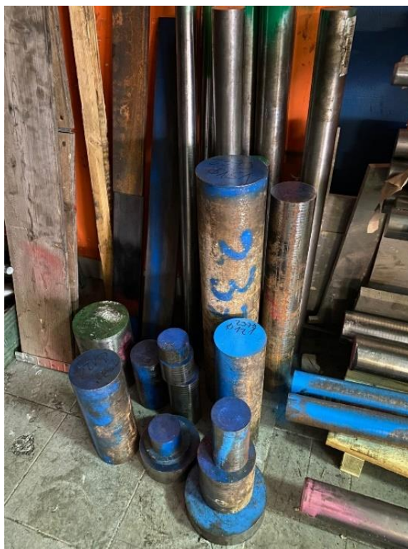
Slika 26. Sirovi komad za tokarenje od čelika X155CrVMo12-1
