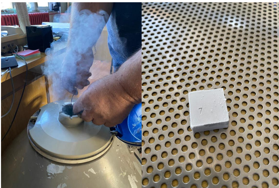
Slika 42. Uranjanje uzoraka u tekući dušik te izgled uzorka nakon dubokog hlađenja
