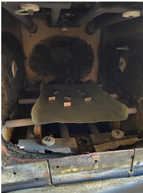
Slika 40. Uzorci u vakuumskoj peći
