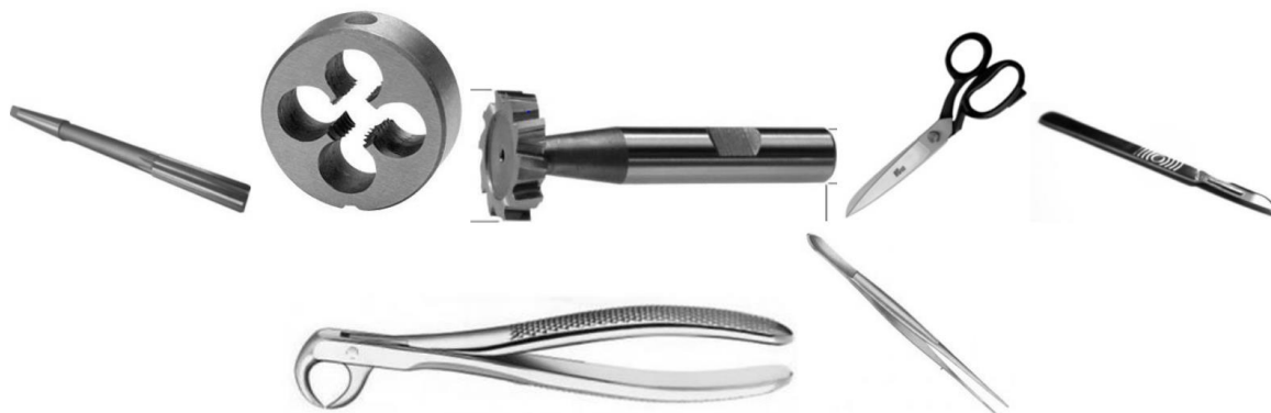
Slika 3. Primjeri visoko-legiranih alatnih čelika [3]
