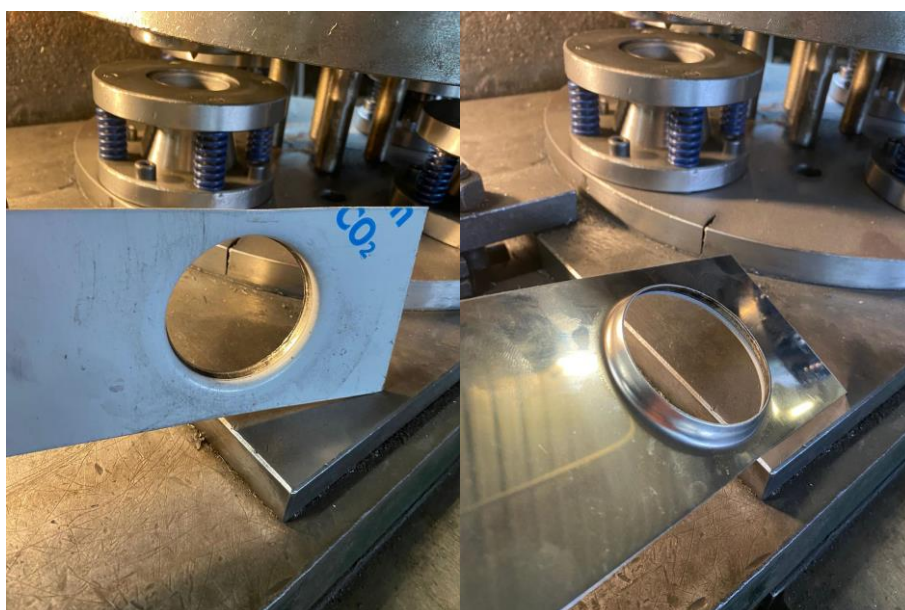
Slika 49. Izgled lima nakon probijanja izrađenim alatom
