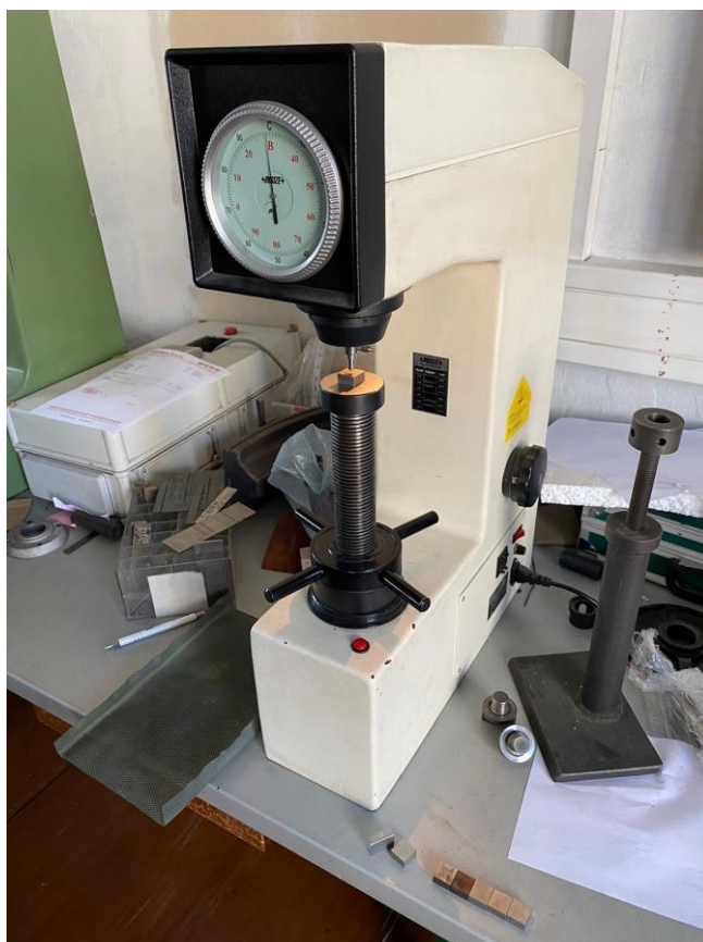
Slika 44. Tvrdomjer prema Rockwell metodi
