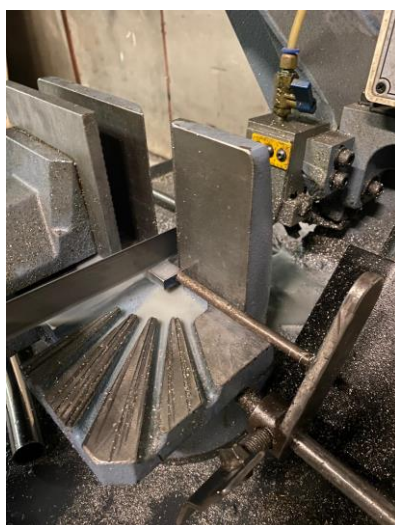
Slika 29. Rezanje na željene dimenzije na tračnoj pili
