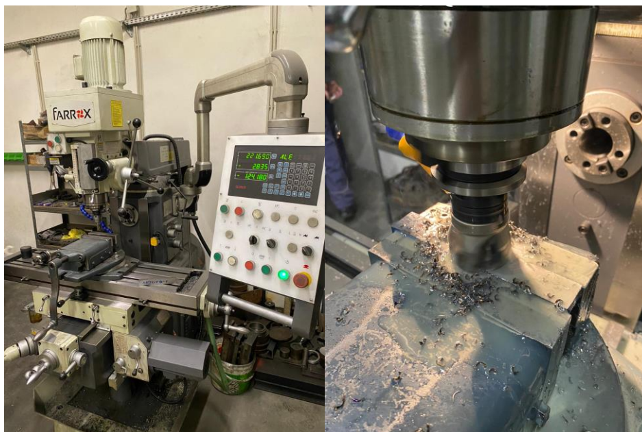
Slika 28. Obrada odvajanjem čestica – glodanje
