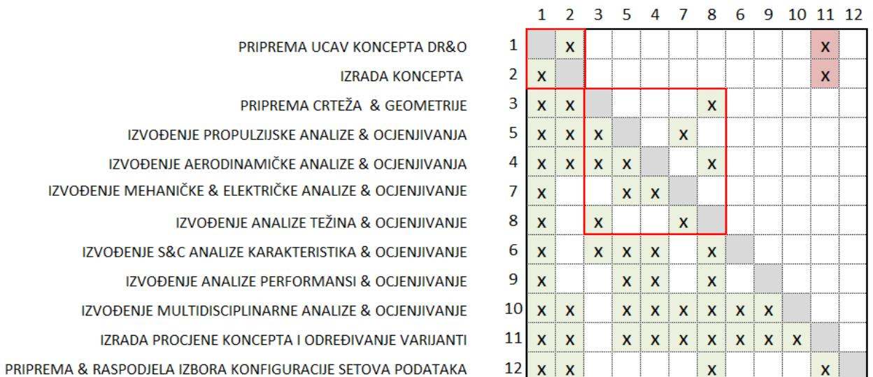
**Slika 3.17.** DSM procesa UCAV vozila nakon particioniranja
