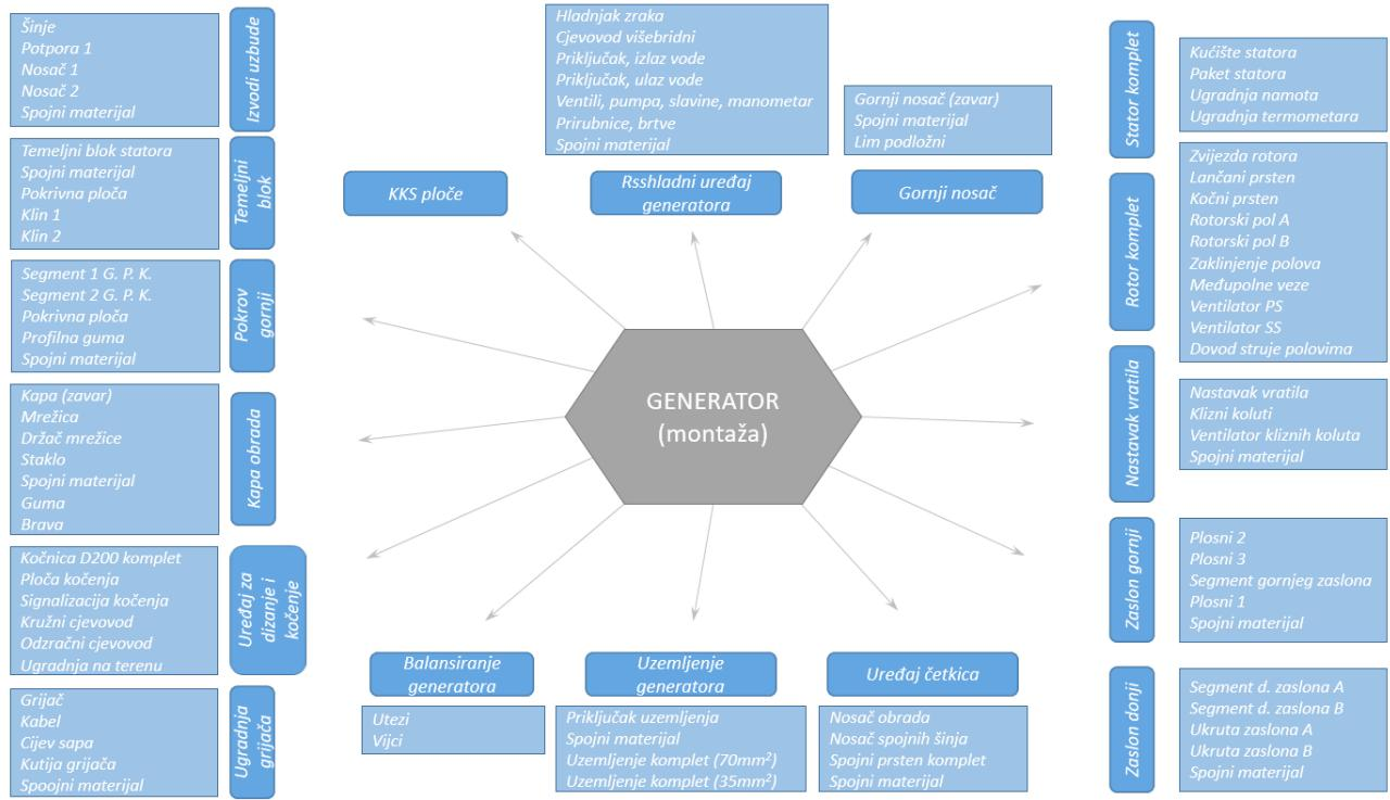
**Slika 2.4.** Shema strukture konstrukcijske dokumentacije velikog generatora prema [79]
