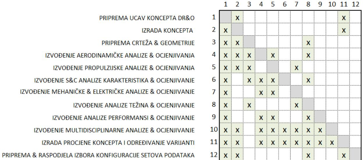
**Slika 3.16.** DSM procesa UCAV vozila prije particioniranja
