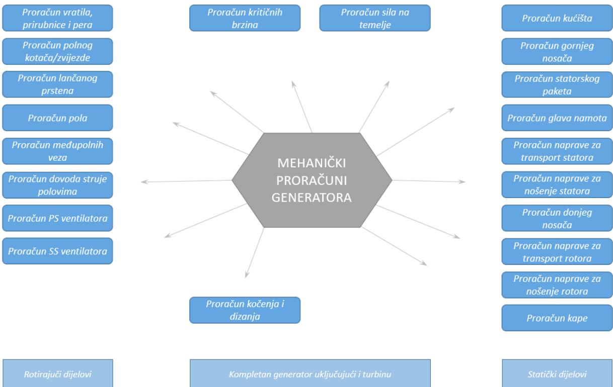
**Slika 2.5.** Uobičajeni mehanički proračuni za veliki generator prema [79]
