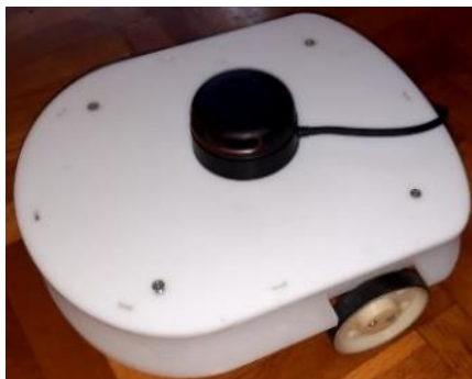
Slika 23. LiDAR u sklopu mobilnog robota: (a) RPLiDAR A2 uređaj; (b) model LiDAR uređaja korišten u simulaciji (CoppeliaSim; jedna zraka svakih 36°); (c) RPLiDAR A2 uređaj instaliran na eMIR-u..
