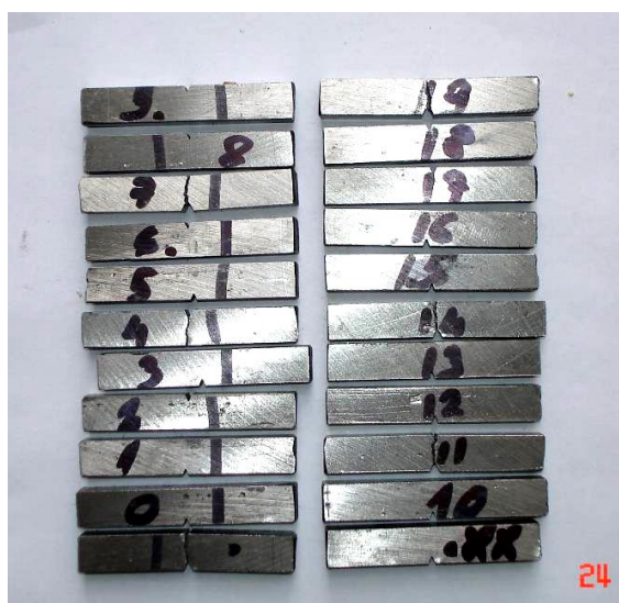
Slika 67: Charpy V uzorci za ispitivanje udarnog rada loma
