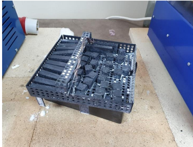
Slika 141: Košarica s uzorcima nakon vađenja iz solne kupke
