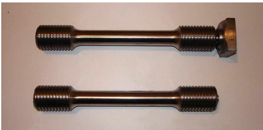
Slika 63: Uzorak za statičko vlačno ispitivanje
