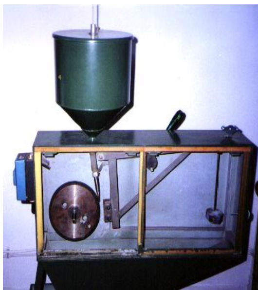
Slika 94: Uređaj „suhi pijesak/gumeni kotač“
