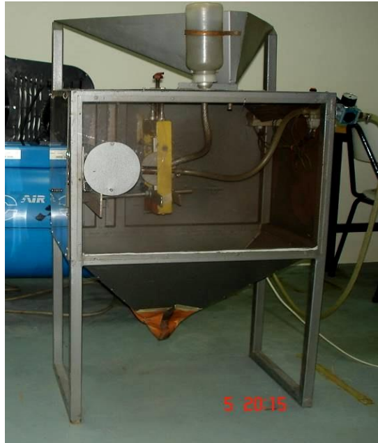
Slika 91: Uređaj za kugličarenje UZK-1
