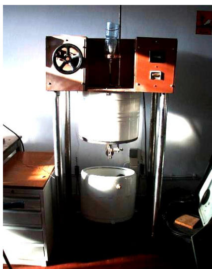
Slika 98: Uređaj za ispitivanje otpornosti na eroziju suhim česticama
