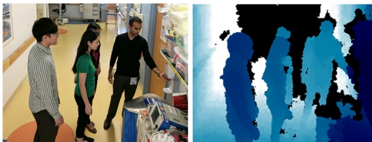
Slika 19. Slika pomoću obične kamere i slika dobivenom dubinskom kamerom; Stanford AI Blog [39]
