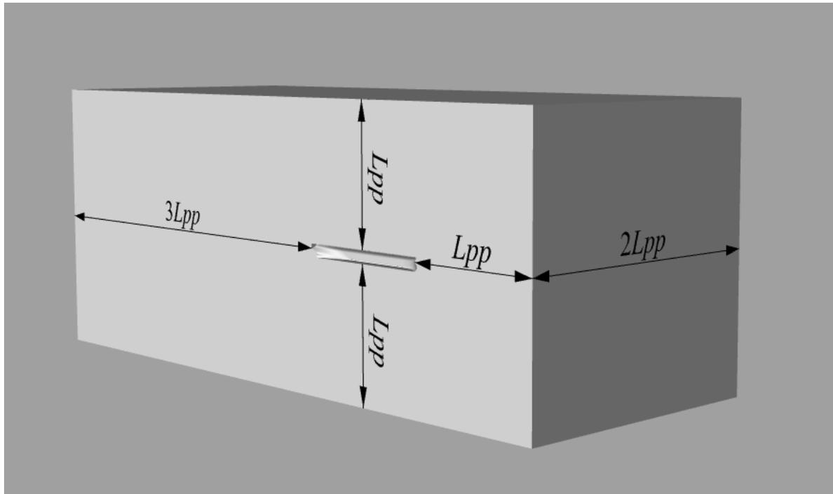
**Slika 8. Dimenzije domene numeričke simulacije pokusa otpora**
