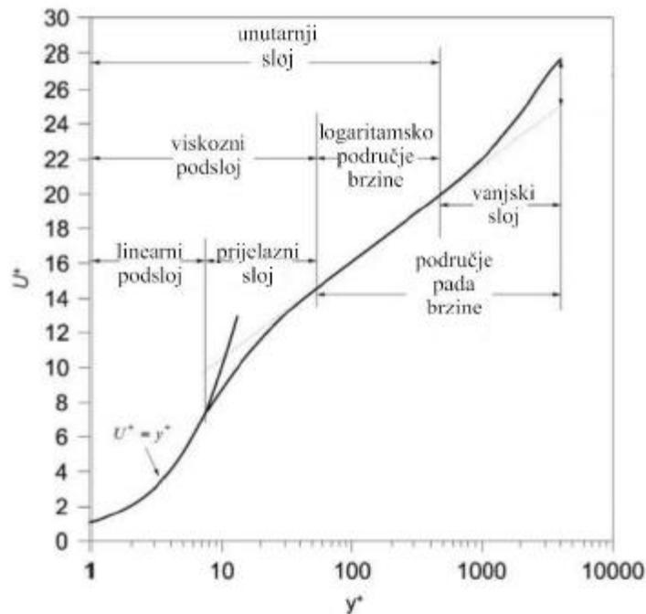
Slika 6. Prikaz profila brzine unutar turbulentnog graničnog sloja [20]
