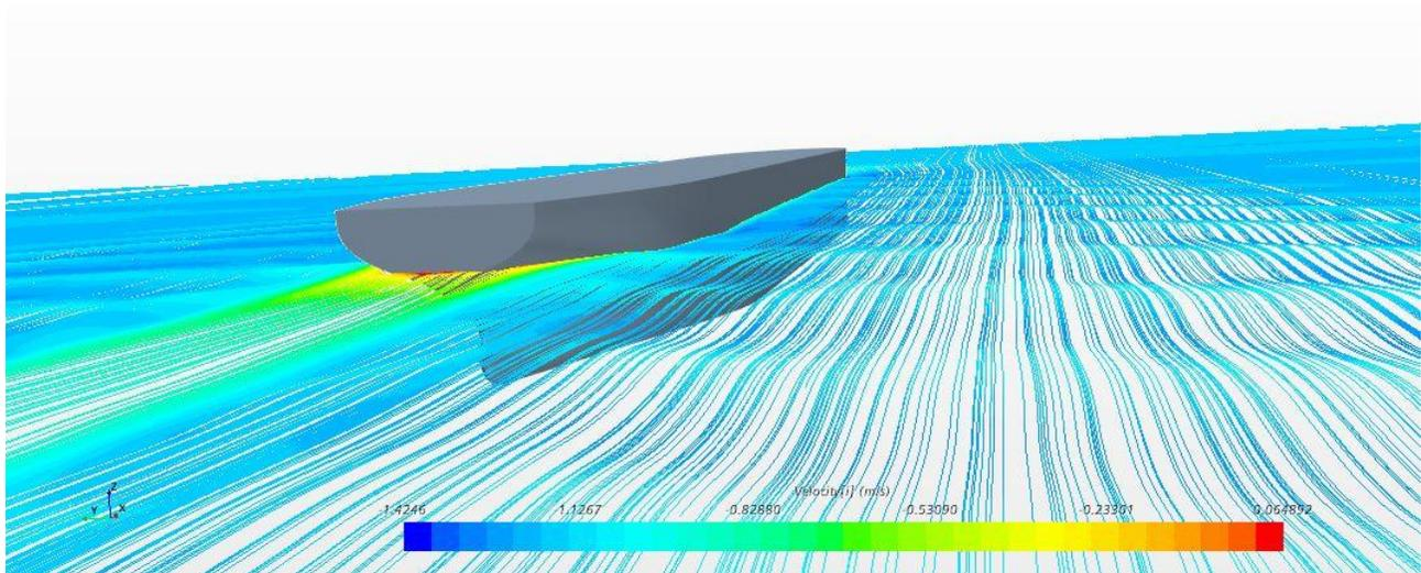
**Slika 24. Prikaz strujnica na slobodnoj površini iza krme**
