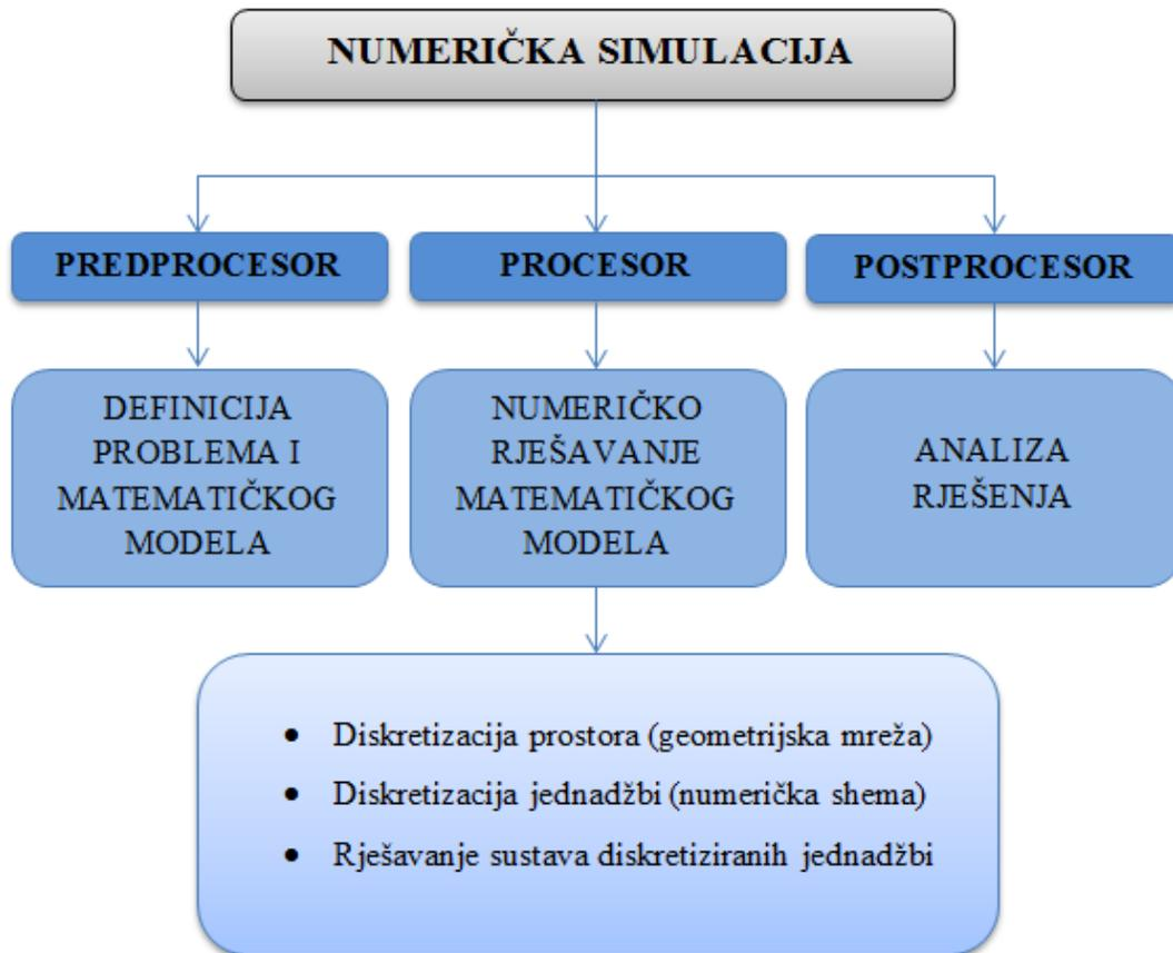
Slika 2. Shematski prikaz postupka provođenja numeričke simulacije
