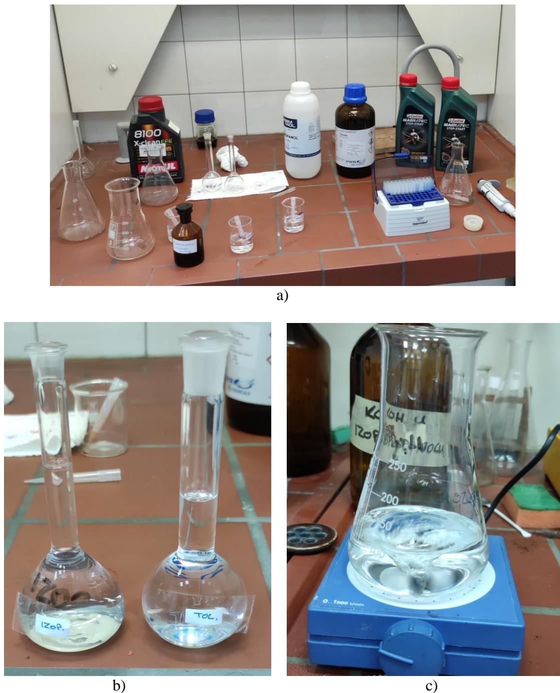
**Slika 3. Prikaz pokusa utvrđivanja kiselinskog broja ulja: a) raspored potrebnih kemikalija u laboratorijskom digestoru, b) odmjerne tikkvice s uzorcima toluena i izopropanola, c) miješanje kemikalija na magnetnoj miješalici.**
