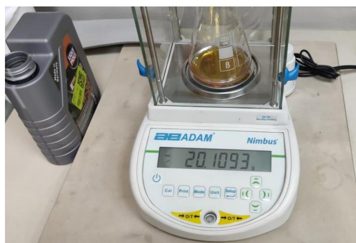
**Slika 2. Odvagani uzorak nakon postupka tariranja**
