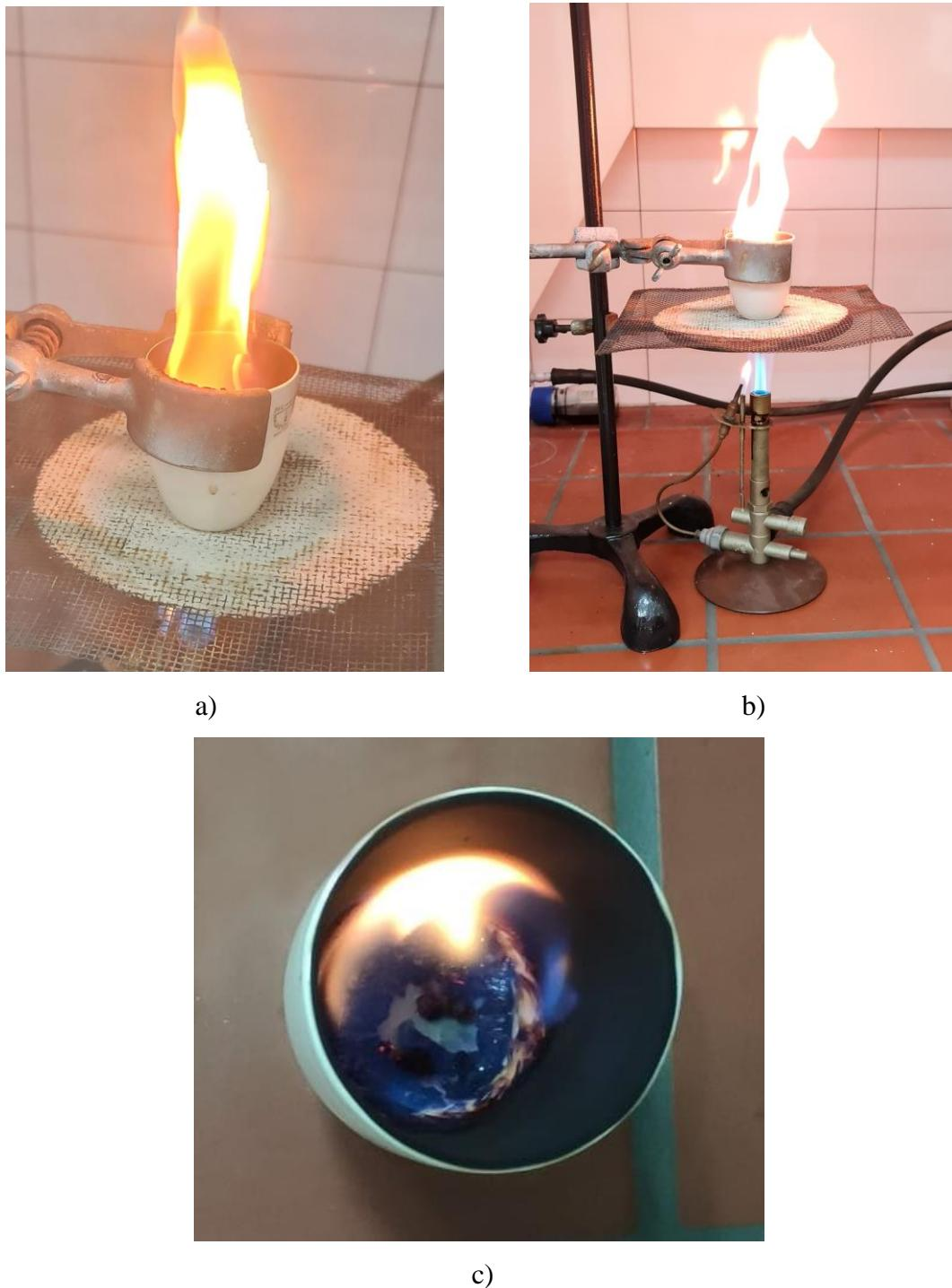
**Slika 8. Prikaz tijeka pokusa utvrđivanja sulfatnog pepela: a) trenutak zapaljenja ulja, b) prikaz potpomaganja procesa izgaranja plinskim plamenikom, c) ostatak (naslage ugljika) nakon izgaranja na otvorenom**
