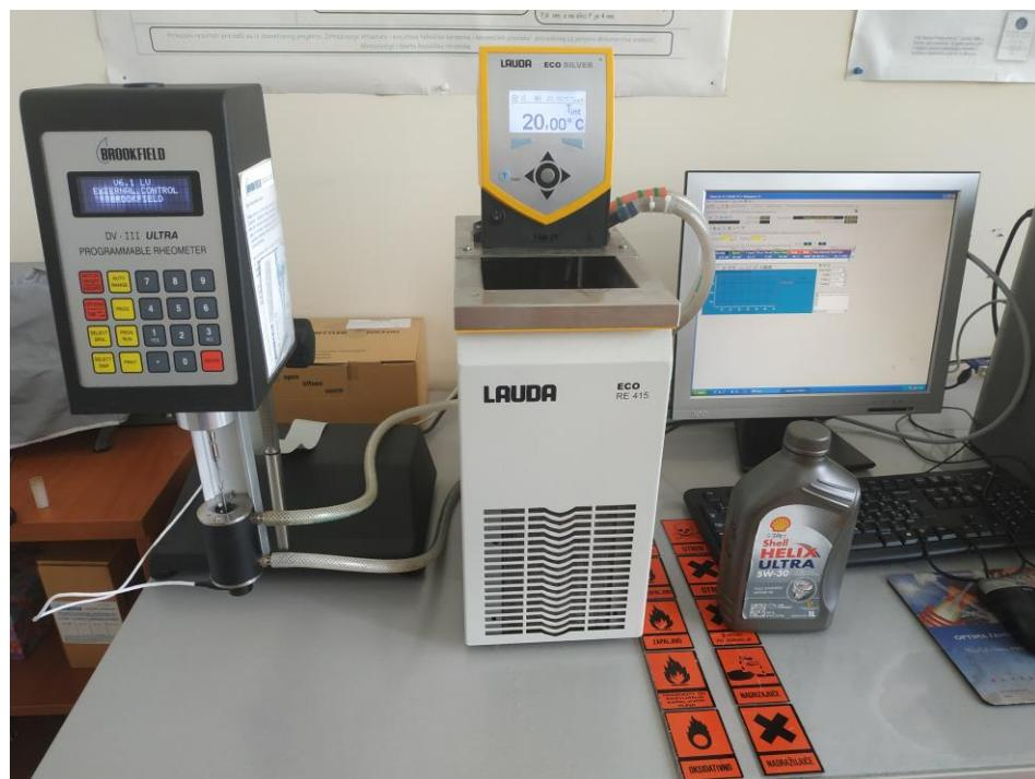
**Slika 5. Eksperimentalni postav za mjerjenje dinamičke viskoznosti rotirajućim tijelom**
