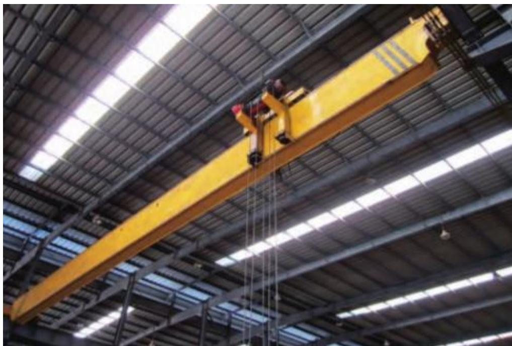
Slika 5. Mosni granik s jednim glavnim nosačem tvrtke DGCRANE [2]
