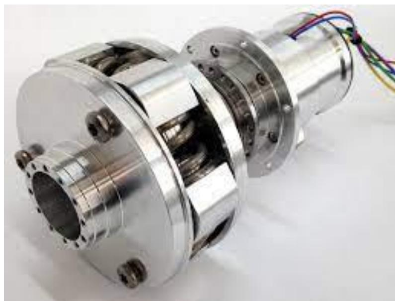
Slika 21. Elastični aktuator [28]
