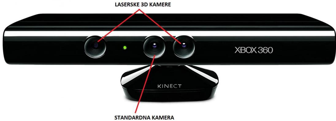
Slika 18. Senzor Kinect [24]
