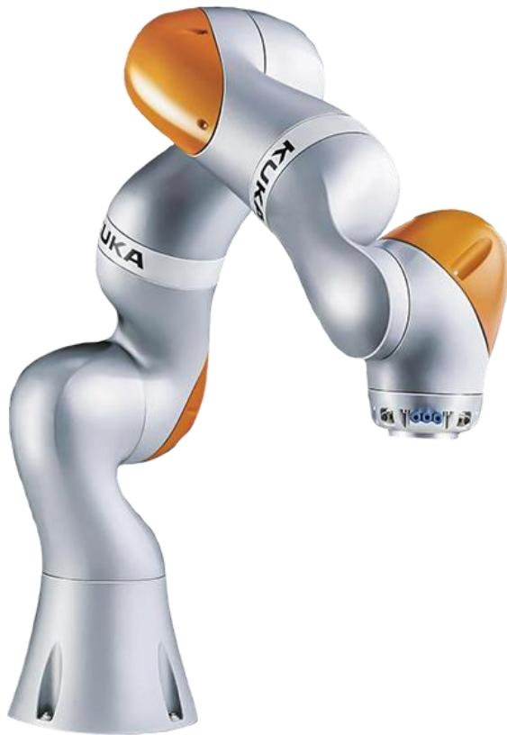
**Slika 23. Robot KUKA LBR iiwa [35]**
