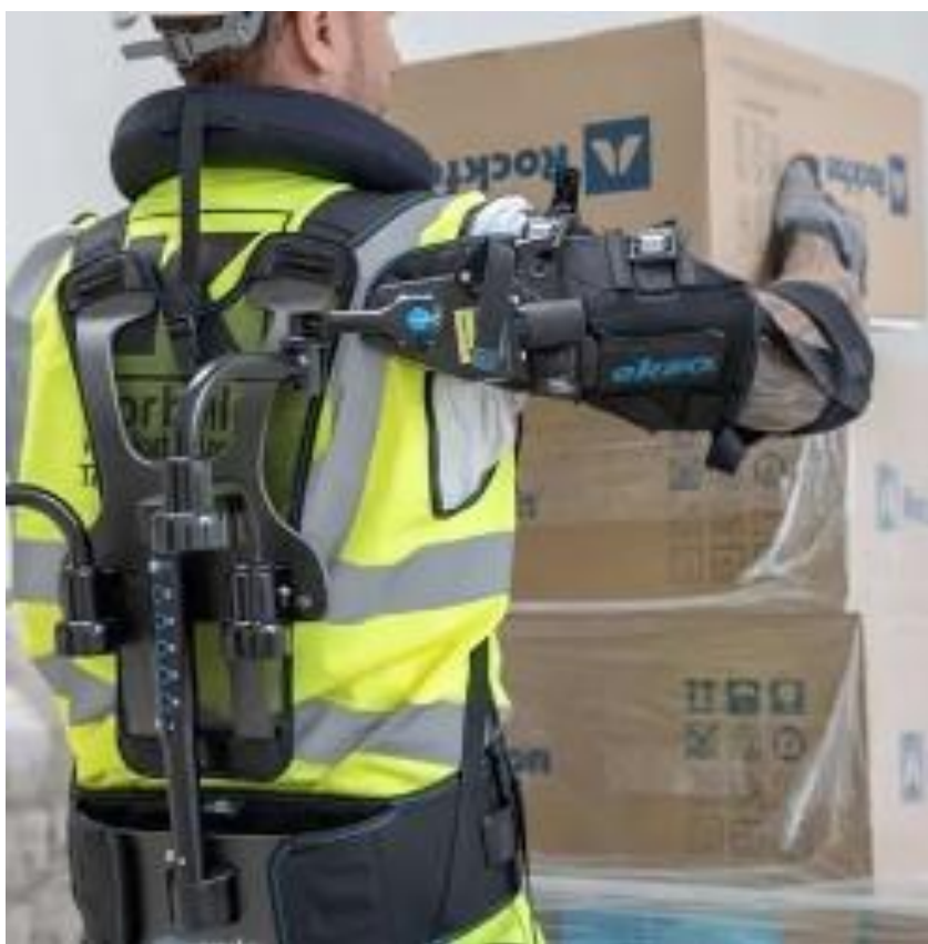
Slika 10. Egzoskelet podržava ruke radnika kod podizanja tereta [16]
