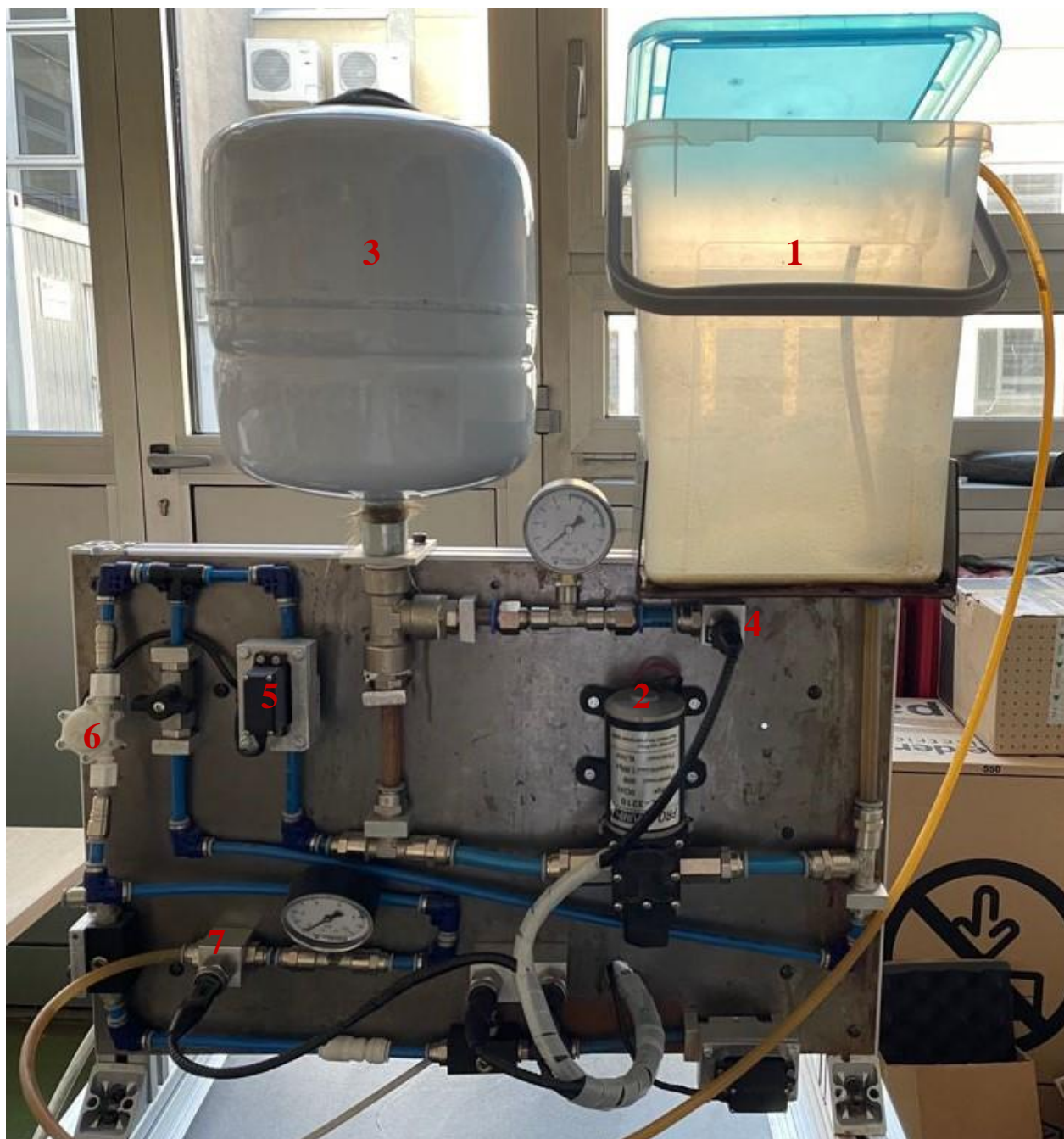
Slika 1 Postav za regulaciju rashladnog sredstva (hidrauličke komponente)
