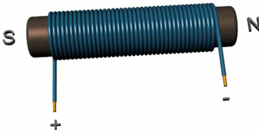
Slika 4. Bakreni namotaji oko željezne jezgre [3]
