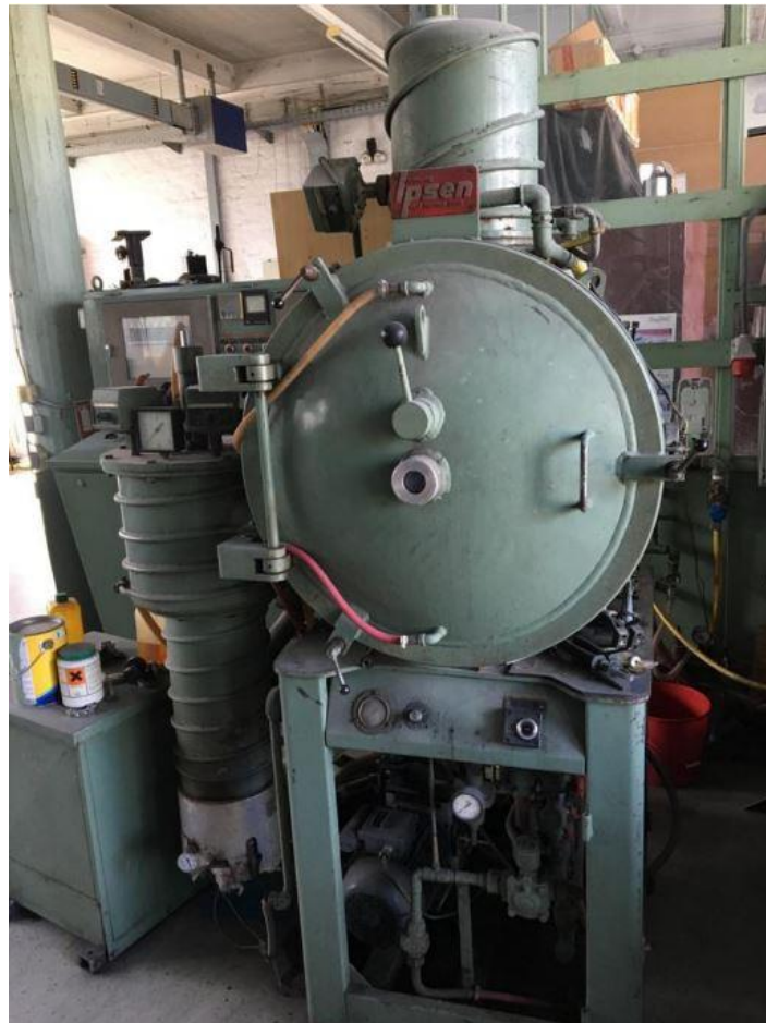
Slika 13. Vakuumska peć VFC25 (Proizvođač: Ipsen GmbH, Njemačka)
