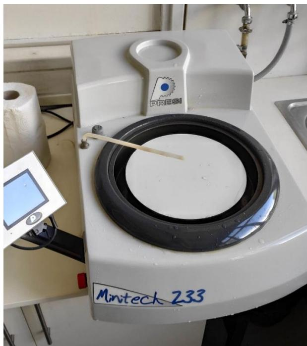
Slika 15. Laboratorijski uređaj za brušenje Minitech 233
