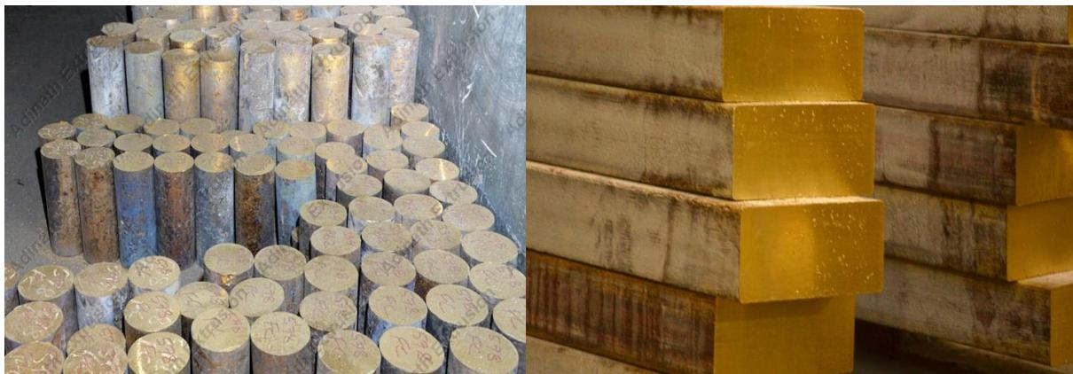
Slika 4. Mjedene gredice [20] (lijevo) i ploče [21] (desno)
