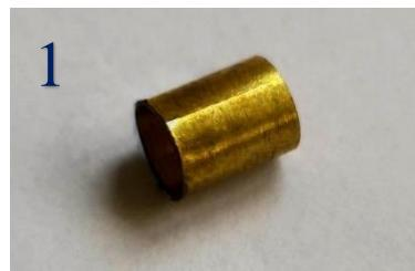
**Slika 11. Osnovni uzorak od mjeđene legure CuZn20**
