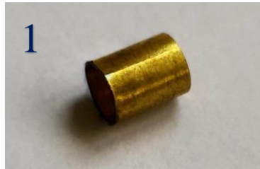
Slika 11. Osnovni uzorak od mjedene legure CuZn20
