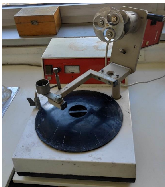
Slika 16. Uređaj za poliranje Struers Pedemin
