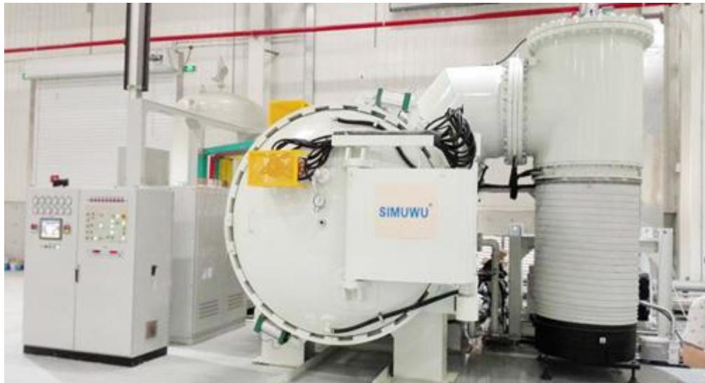
Slika 10. Vakuumska peć za lemljenje pri visokim temperaturama [27]
