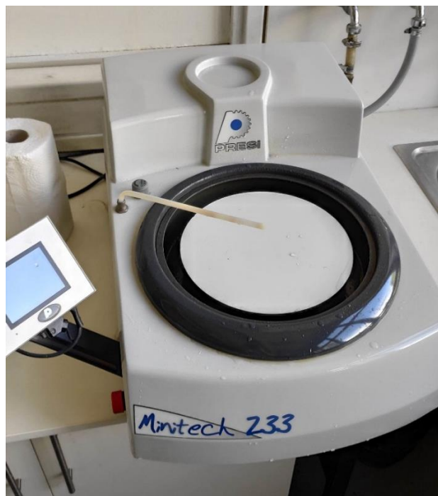
Slika 15. Laboratorijski uređaj za brušenje Minitex 233
