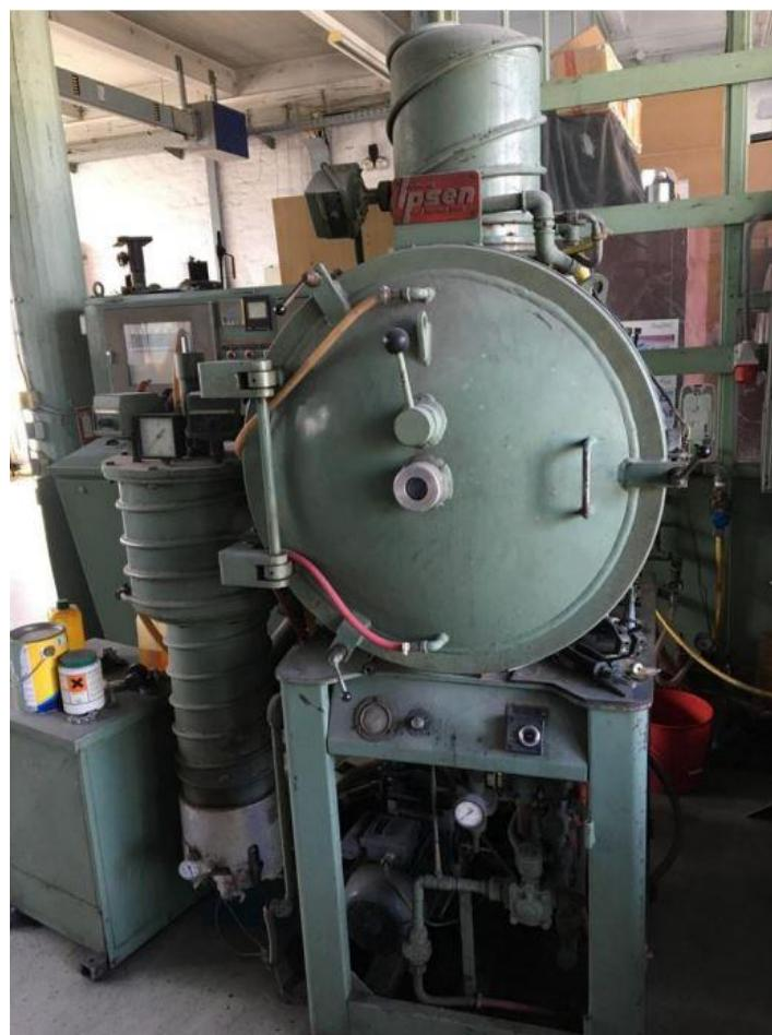
Slika 13. Vakuumska peć VFC25 (Proizvodač: IpsenGmbH, Njemačka)
