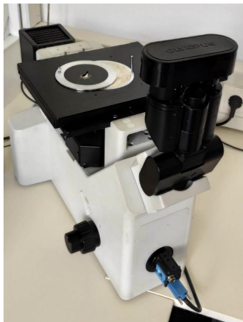
Slika 18. Svjetlosni mikroskop Olympus GX51
