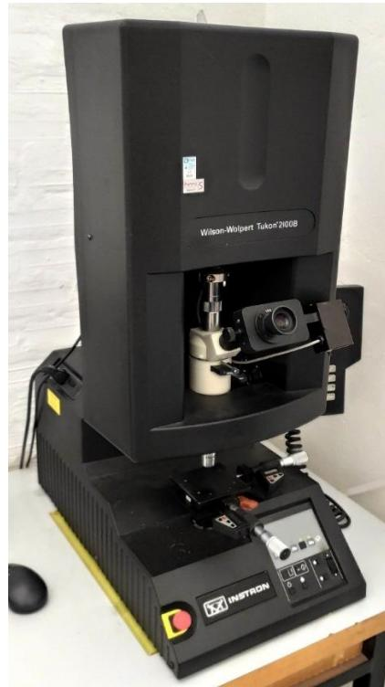
**Slika 22. Uredaj za mjerjenje mikrotvrdoće Tukon 2100B**
