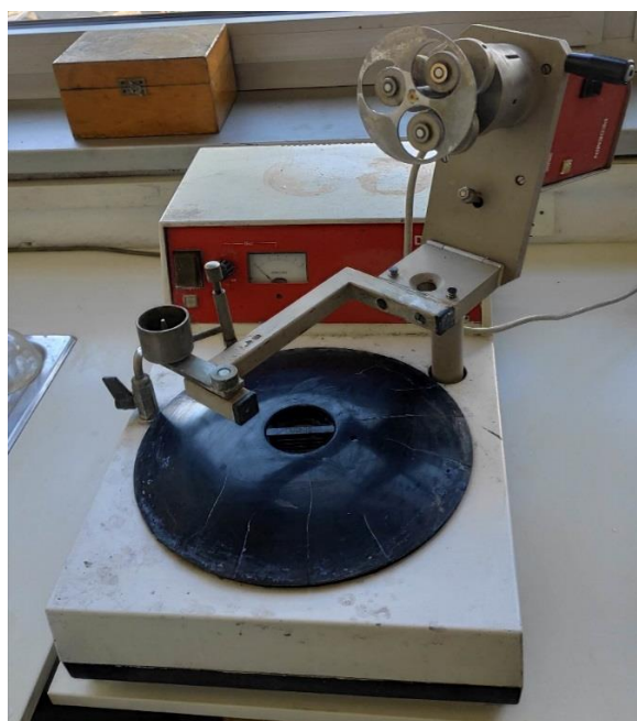
Slika 16. Uređaj za poliranje Struers Pedemin
