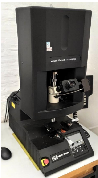
Slika 22. Uređaj za mjerenje mikrotvrdoće Tukon 2100B
