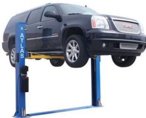
Slika 12. Radionička stupna podizna platforma
