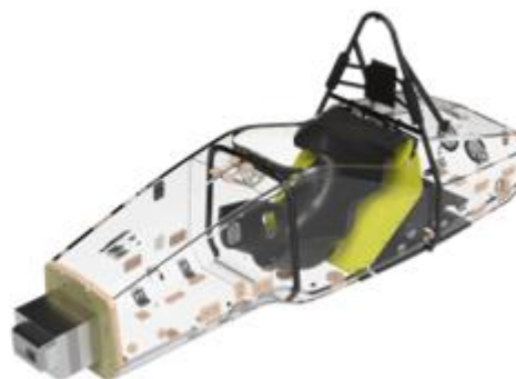
Slika 3. Bolid VulpesR i renderirani prikaz monokok šasije sa pridruženim elementima šasije
