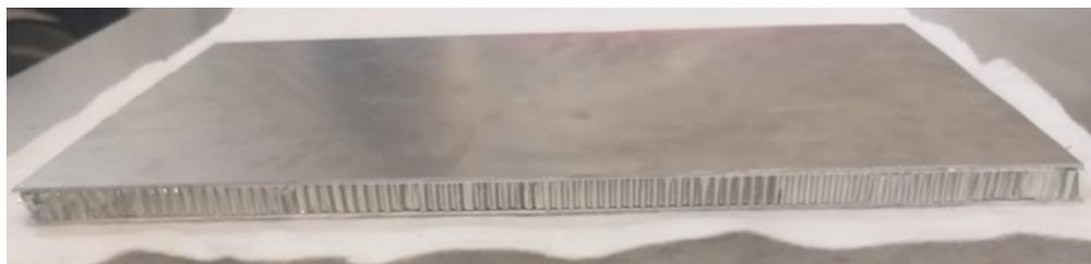
Slika 40. Oblik sendvič konstrukcije nakon slaganja
