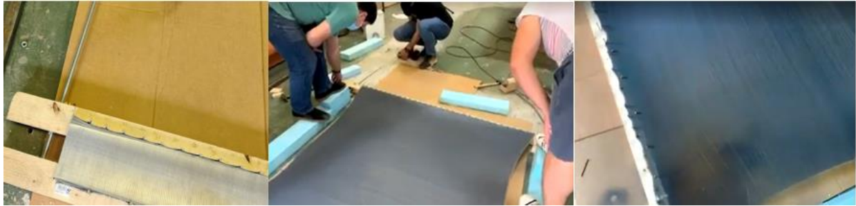
Slika 12. Ekspandiranje aluminijskih saća u prostorijama FSB Racing Team-a
