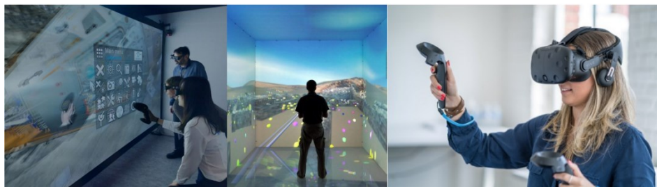
Slika 1 Powerwall sustav (lijevo), CAVE sustav (sredina) i HMD sustav (desno)
