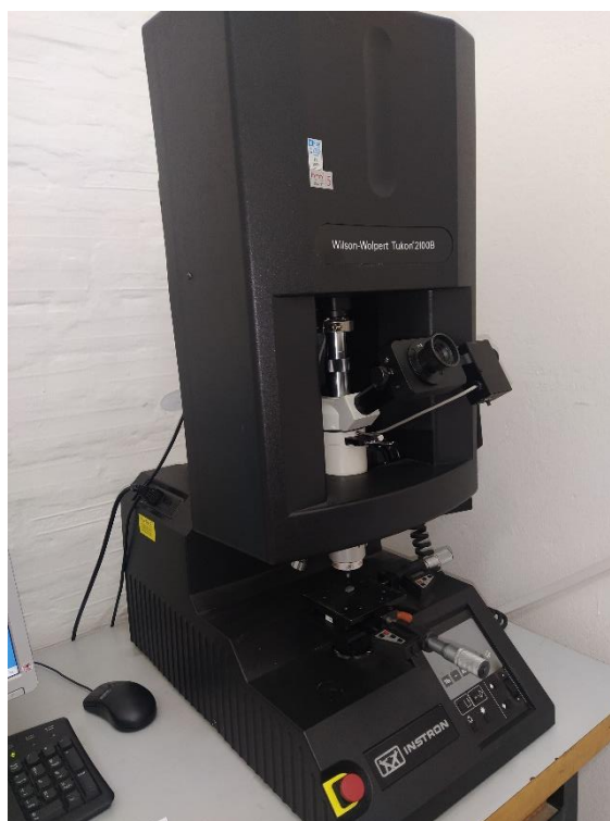
Slika 30 Uređaj za mjerenje tvrdoće Tukon 2100b
