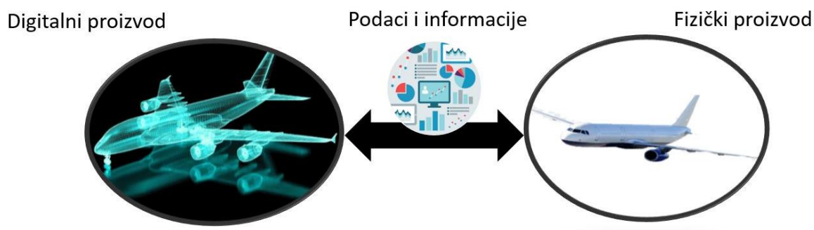
Slika 2.1. Shematski prikaz modela digitalnog blizanca
