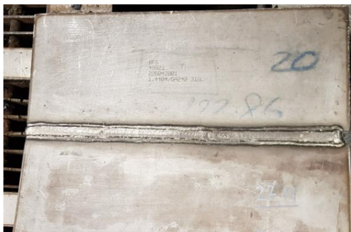
Slika 17. Zavareni uzorak materijala X2CrNiMo17-12-2
