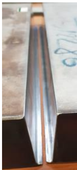
Slika 12. U-priprema radnog komada
