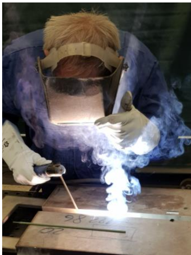
Slika 16. Proces izrade zavora REL tehnologijom
