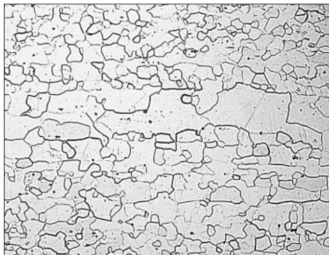
Slika 3. Mikrostruktura feritnih nehrđajućih čelika [9]
