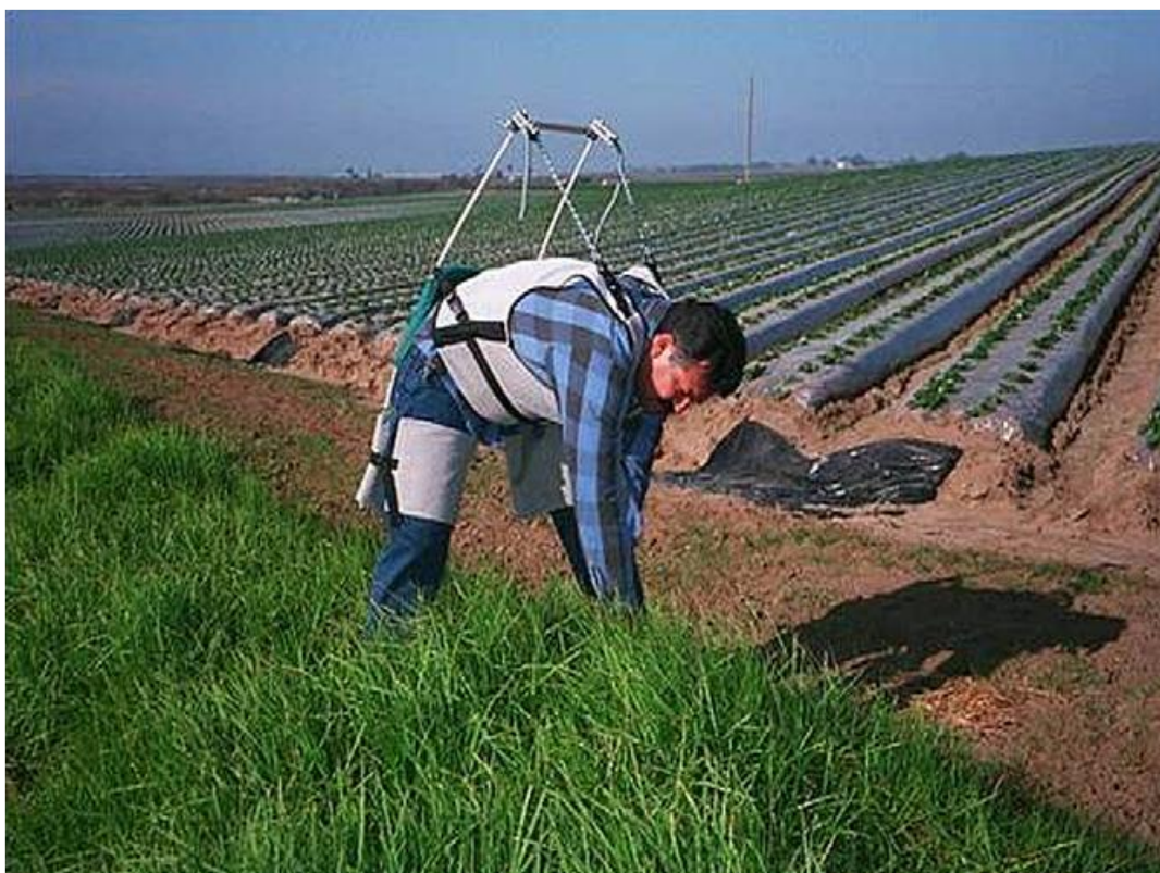
Slika 27. Osobna naprava za prijenos opterećenja [4]
