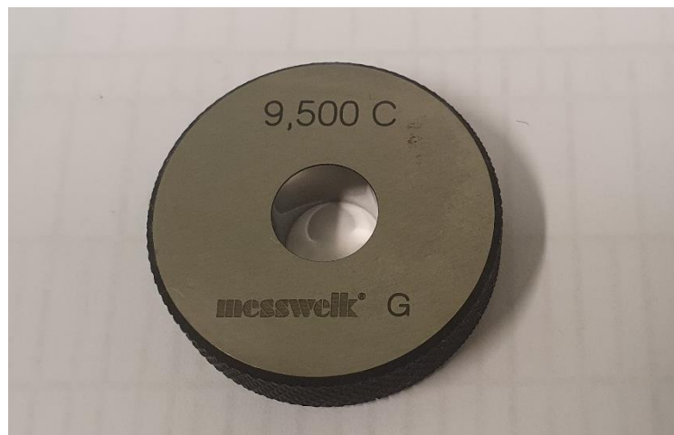
Slika 14. Mjerni kontrolni prsten promjera \varnothing 9,5 mm
