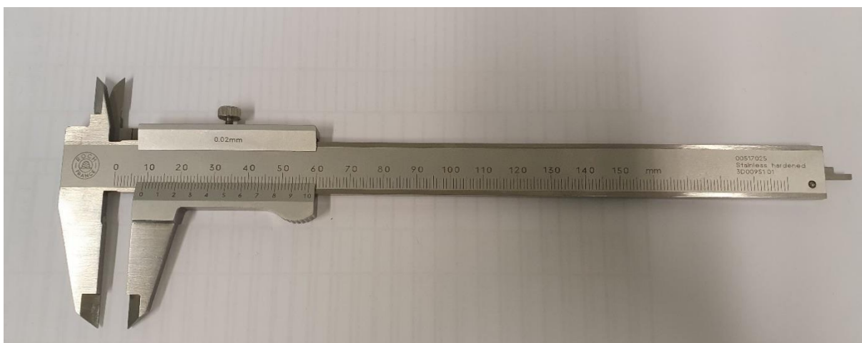
Slika 16. Ručno pomično mjerilo tvrtke Roch France
