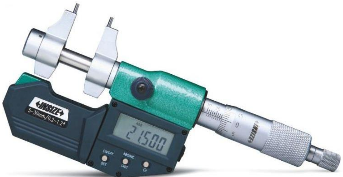
Slika 10. Digitalni mikrometar za unutarnja mjerenja [14]
