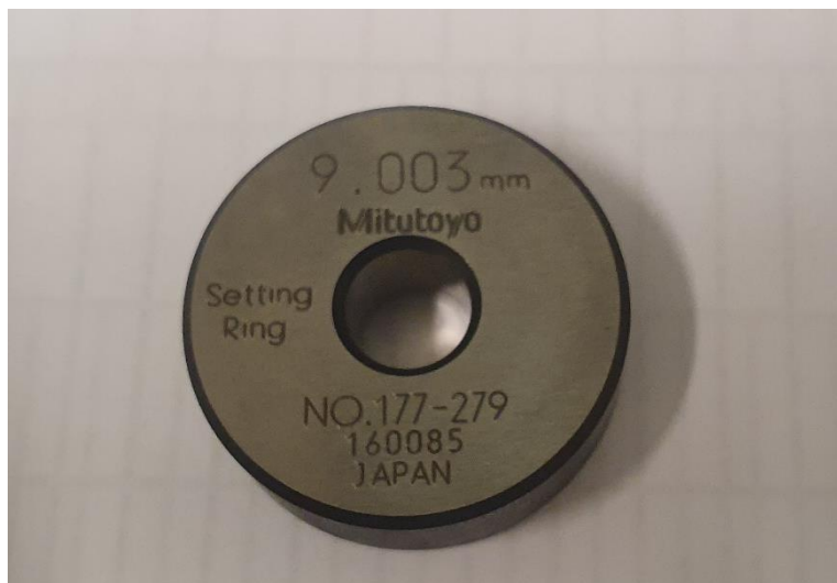
Slika 13. Mjerni kontrolni prsten promjera \varnothing 9 mm
