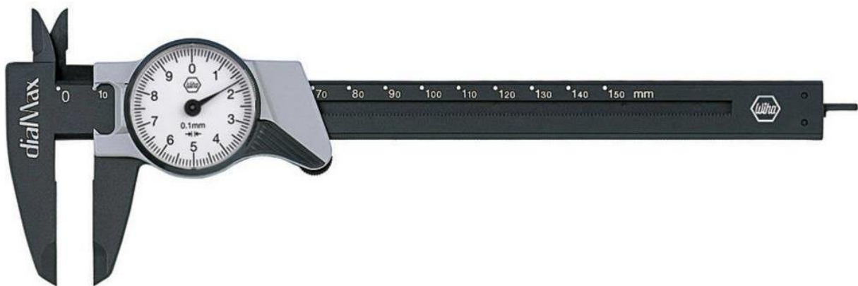
Slika 4. Pomično mjerilo s mjernom urom [8]
