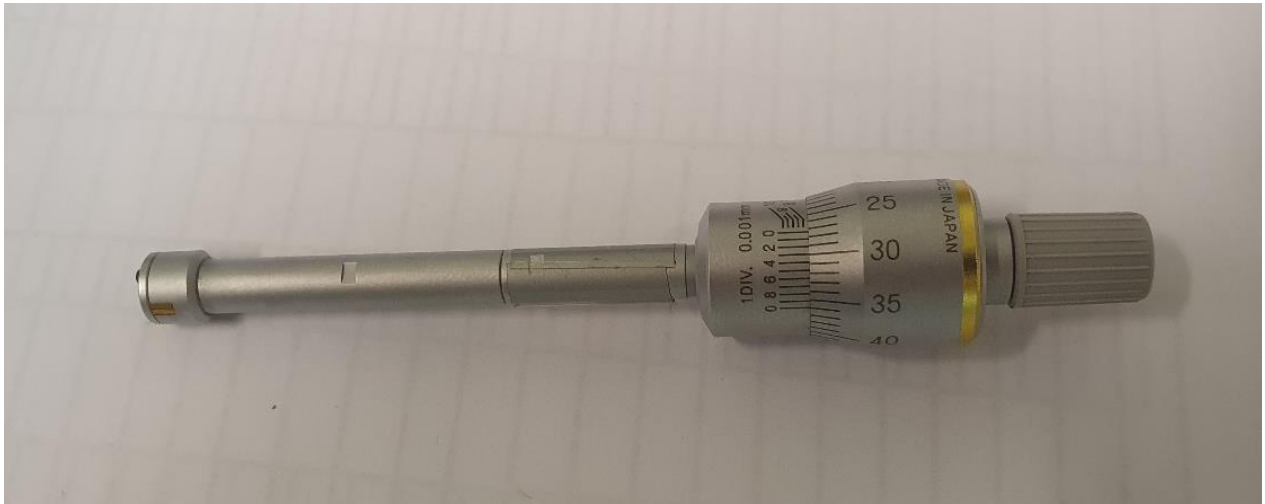
Slika 17. Trokraki mikrometar tvrtke Mitutoyo
