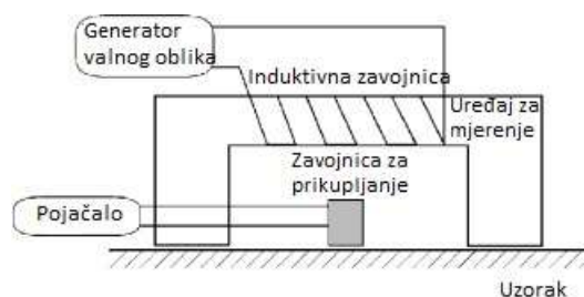
Slika 33. Shematski prikaz mjerenja zaostalih napreznja pomoću Barkhausen - ove metode [25]
