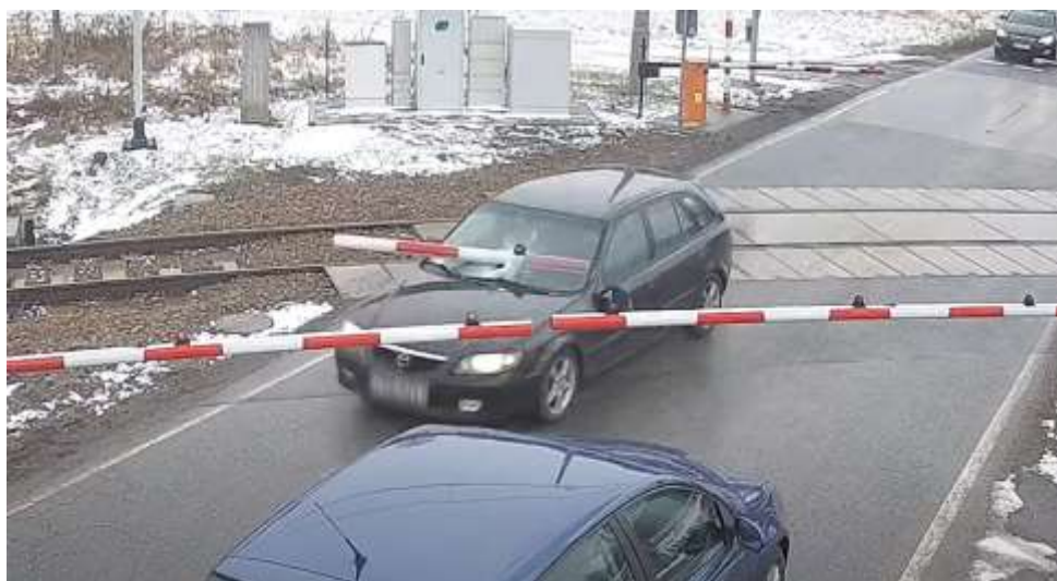
Slika 17. Opasnost od odlomljenog dijela polubranika [24]
