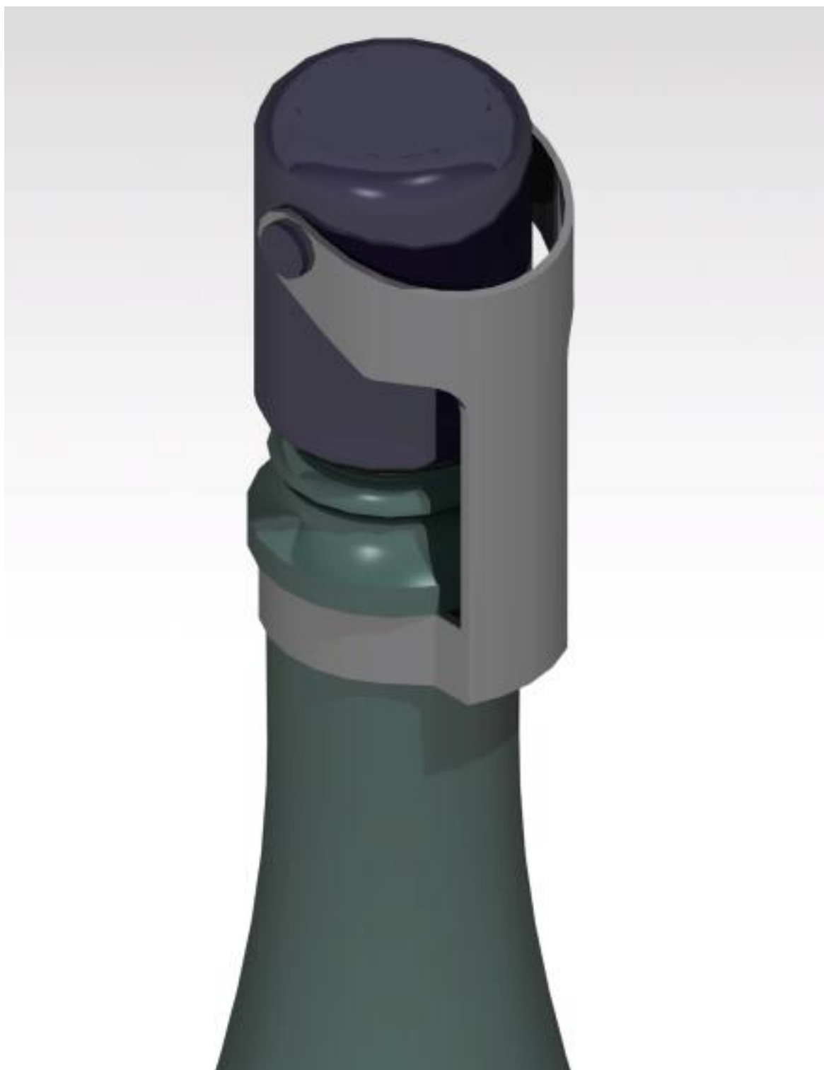
Slika 27. Sklop boce i Smartcorka sa zateznom polugom
