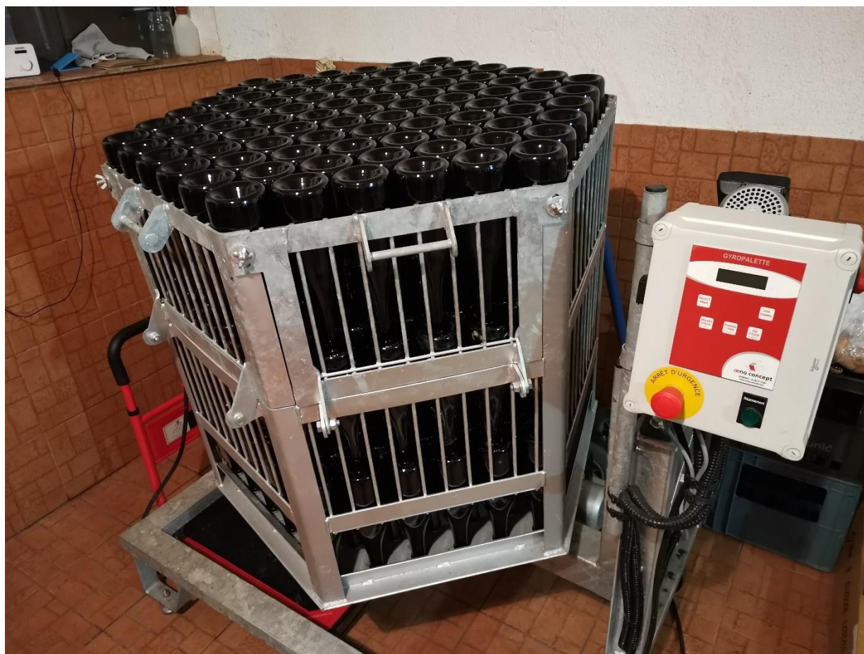
Slika 8. Giro-paleta za okretanje pjenušca kapaciteta 300 boca
