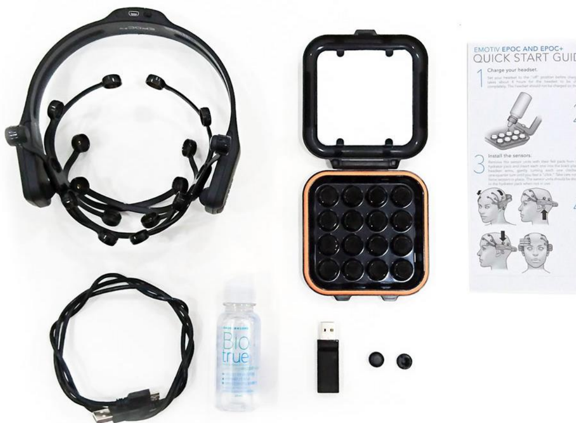
Slika 9. Dijelovi uređaja EMOTIV EPOC X [41]
