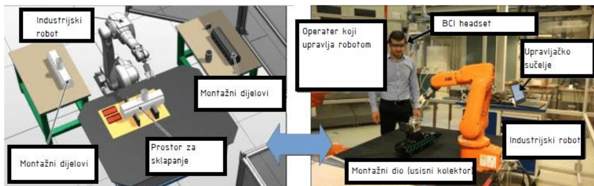
Slika 22. Prikaz industrijskog robota upravljaniog BCI uređajem [60]
