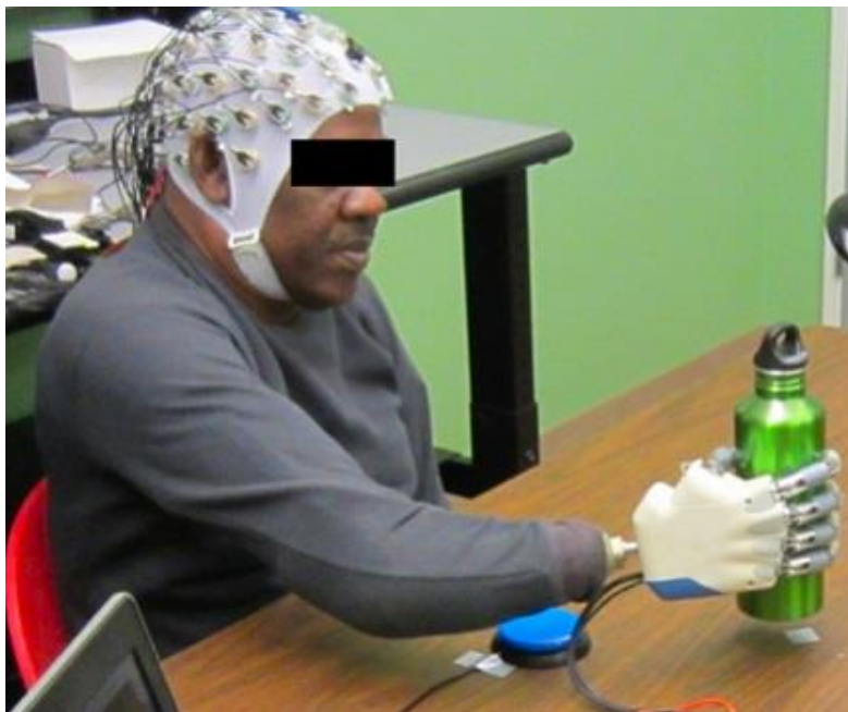
Slika 8. Prostetička ruka kontrolirana signalom EEG [34]
