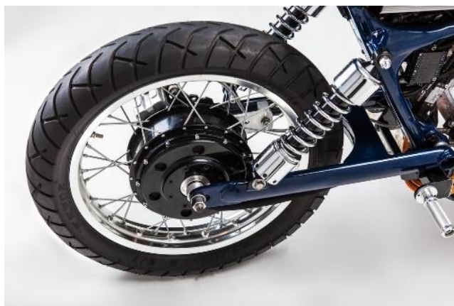
Slika 10. Elektromotor kao dio pogonskog kotača (Hub-drive)
