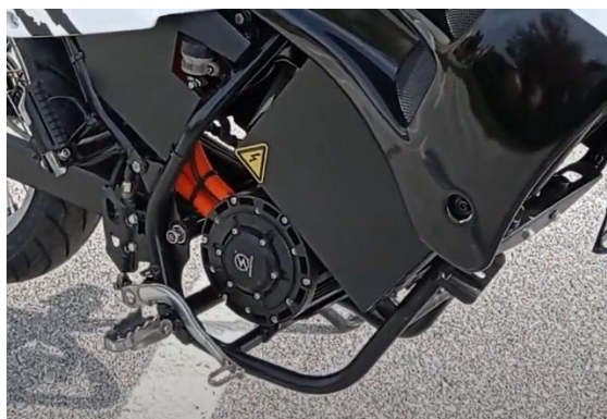
Slika 44. Narančaste instalacije i naljepnica za upozorenje
