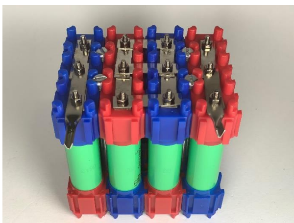
Slika 28. Graničnici sa ugrađenom sabirnicom
