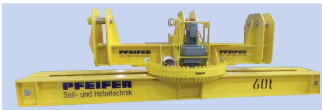
Slika 14. Rotirajući sustav tvrtke Pfeifer
