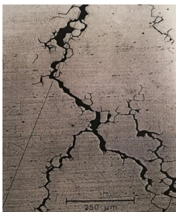
Slika 17. Kaustična napetosna korozija u zoni utjecaja topline [11]
