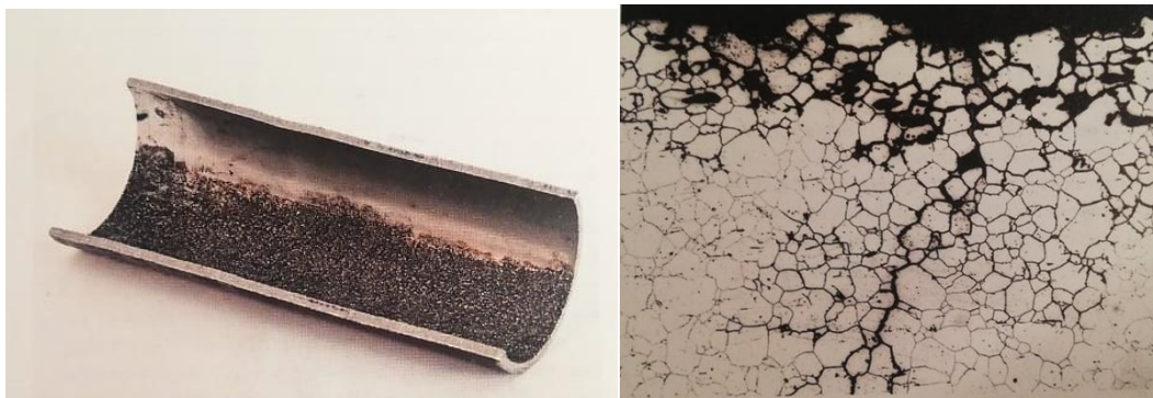
Slika 14. Primjeri interkristalne korozije [10]
