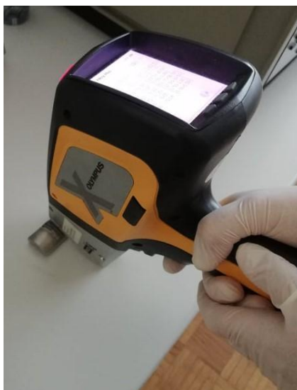
Slika 42. XFR uređaj za ispitivanje kemijskog sastava materijala
