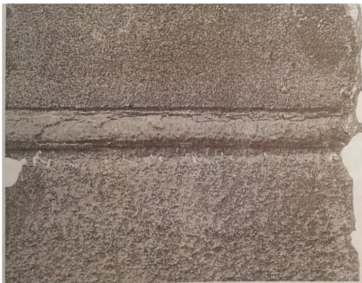
Slika 15. Raspad austenitnog nehrđajućeg čelika interkristalnom korozijom uz zavar [2]
