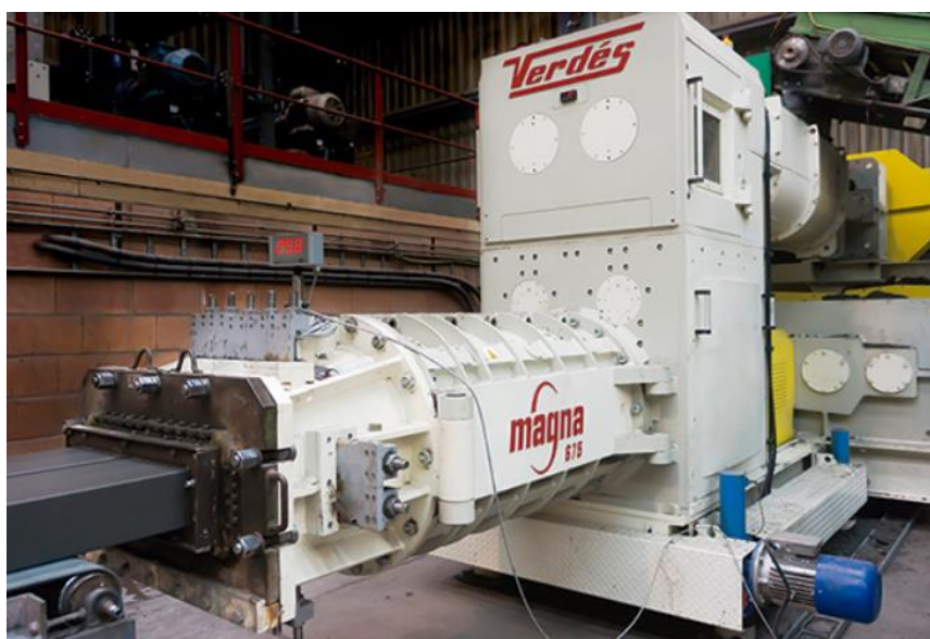
Slika 30. Ekstruder sa sklopnim jedinicama za proizvodnju [29]
