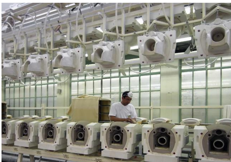
Slika 20. Velikoserijska proizvodnja keramike lijevanjem suspenzije u kalupe [21]
