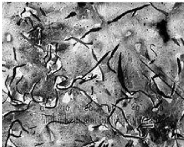
Slika 13. Mikrostruktura sivog lijeva
