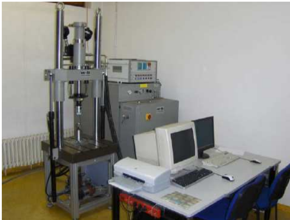
Slika 4.6 Servohidraulička kidalica LFV 50-HH, Walter+Bai
