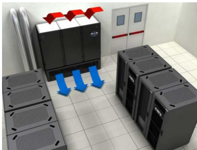
Slika 21. Prikaz „downflow frontal“ tip jedinice u prostoru [3]
