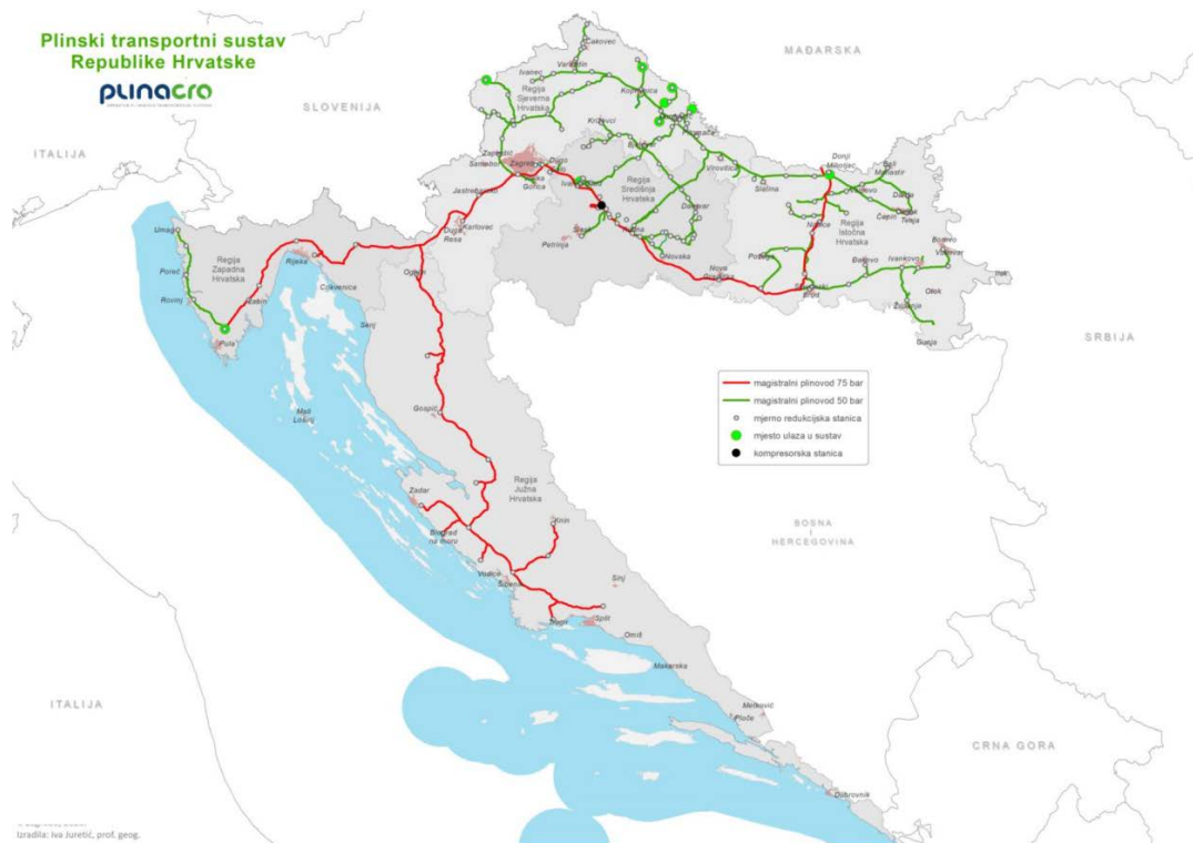
Slika 11. Plinski transportni sustav RH [19]
