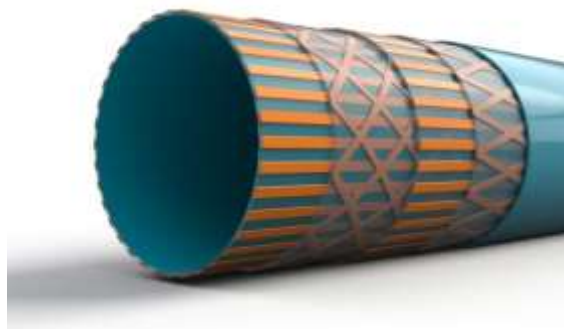
Slika 4.8. Princip pullwinding postupka tvrtke EXEL [27]
