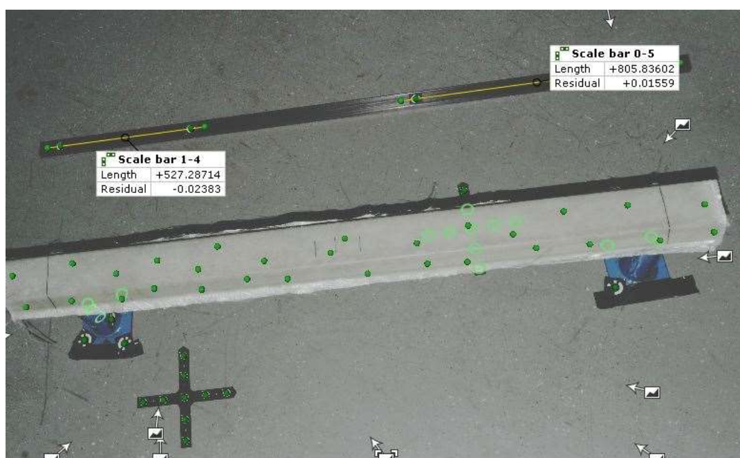
Slika 6.17. Kodirane i nekodirane točke prepoznate na fotografiji (zeleno)
