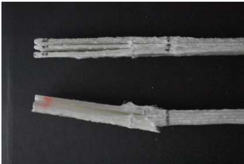
Slika 6.27. Raslojavanje ispitnih tijela
