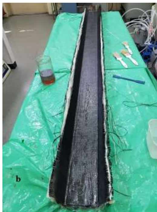
Slika 6.9. Ručno laminiranje profila 3: a) nanošenje smole kistom i istiskivanje zraka, b) početak umreživanja
