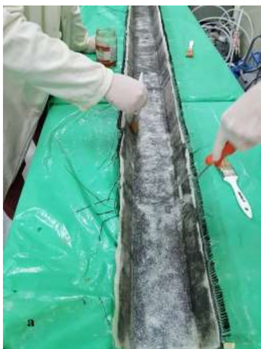
Slika 6.9. Ručno laminiranje profila 3: a) nanošenje smole kistom i istiskivanje zraka, b) početak umreživanja
