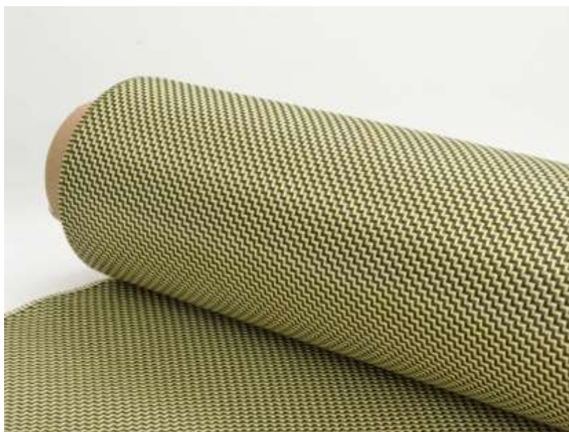
Slika 2.8. Hibridna tkanina, ugljična i aramidna vlakna [38]
