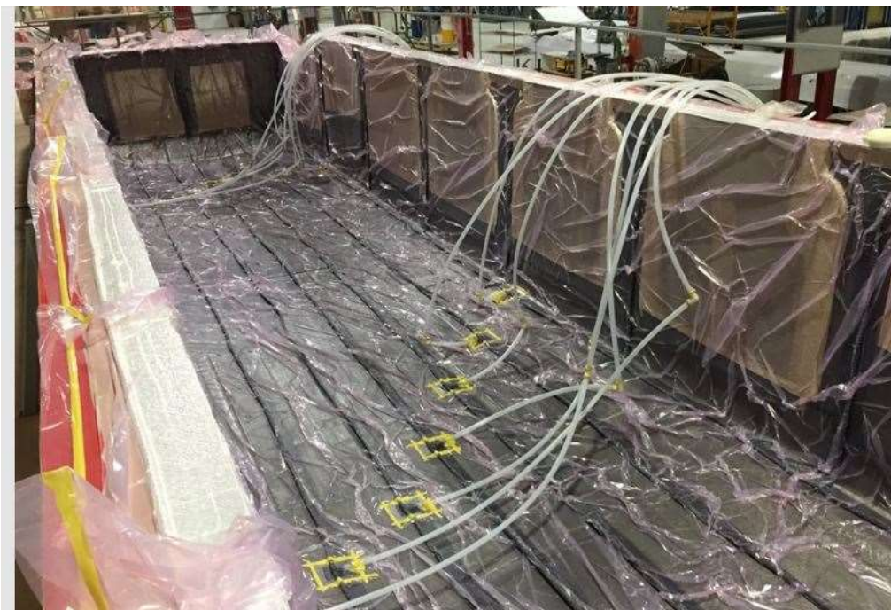
Slika 3.6. Proizvodnja gornjeg dijela šasije SCRIMP postupkom [20]
