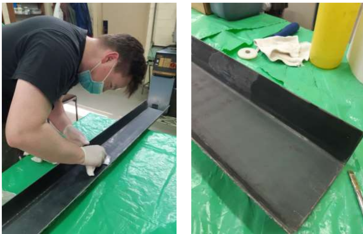
Slika 6.4 Nanošenje i poliranje odvajala
