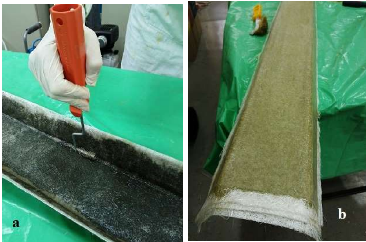
Slika 6.7. Prerada kompozita: a) istiskivanje zraka, b) vađenje gotovog profila iz kalupa
