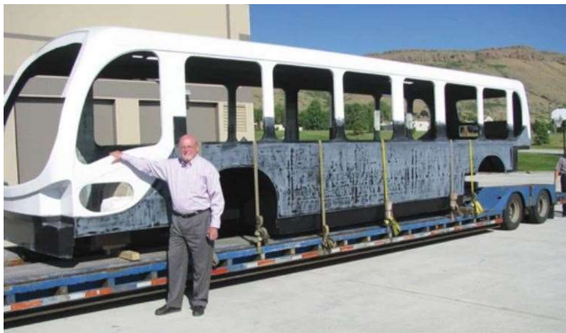
Slika 3.4. Bodywork autobusa EcoRide proizvođača Proterra iz 2005. godine [19]
