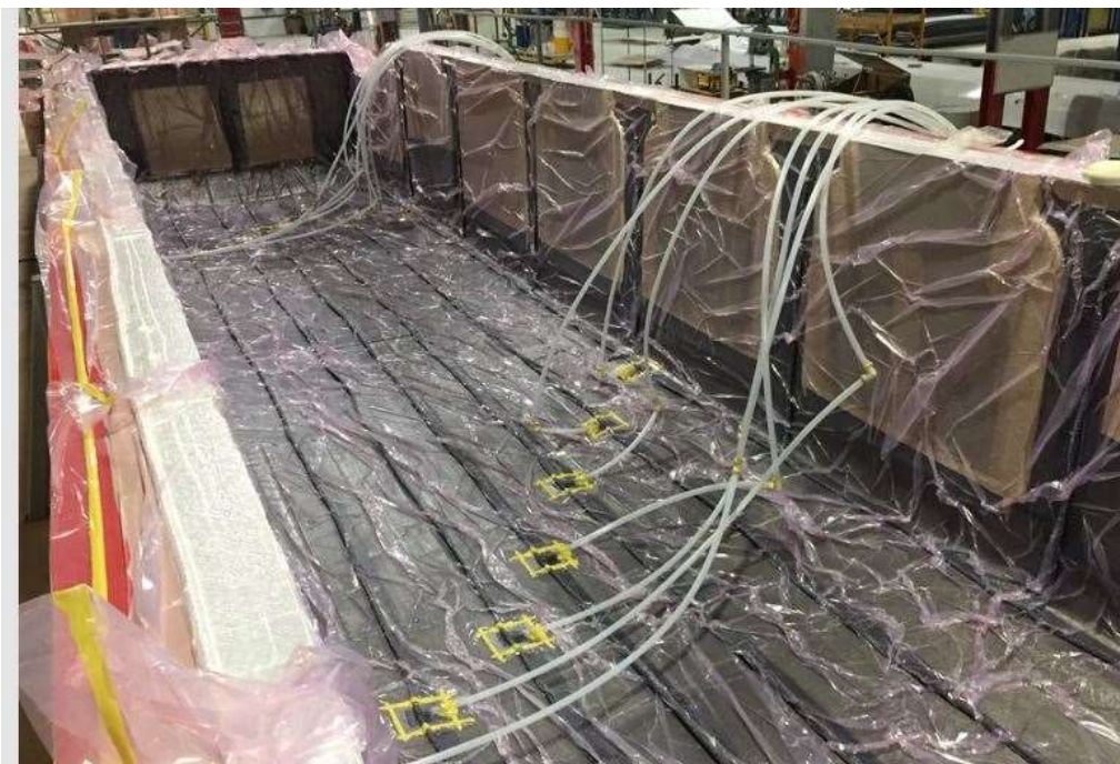
Slika 3.6. Proizvodnja gornjeg dijela šasije SCRIMP postupkom [20]
